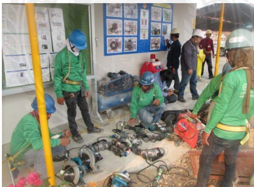
รูปที่ 4.20 การตรวจเช็คอุปกรณ์เครื่องมือไฟฟ้า
