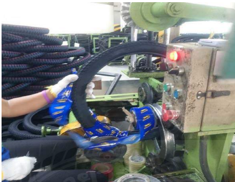
รูปที่ 4.3 การบรรจุภัณฑ์ยางนอกมอเตอร์ไซค์ด้วยพลาสติกพันยาง
