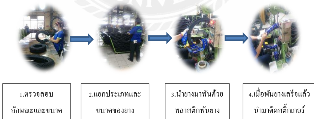
รูปที่ 4.6 แผนผังกระบวนการผลิตในการพินยาง
