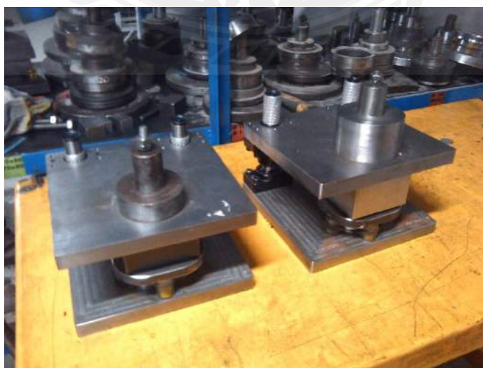
รูปที่ 4.6 แม่พิมพ์รุ่มและแท็บที่ทำและปรับปรุงใหม่
