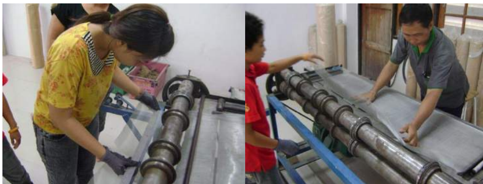
รูปที่ 3.8 การตั้งระยะมิดตัด และการชอยตะแกรง
