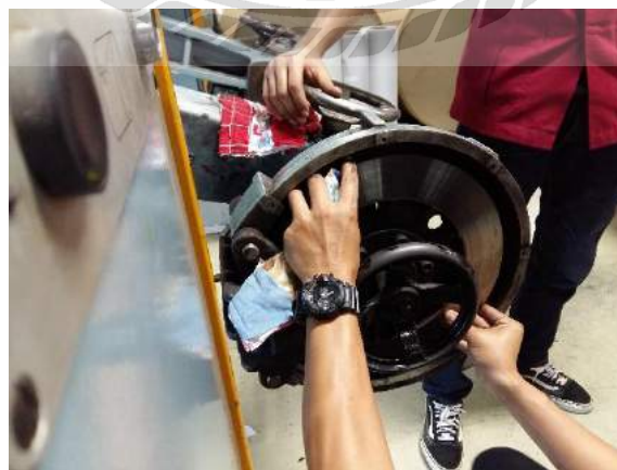
รูปที่ 3.8 ขั้นตอนการถอดและเปลี่ยนงานเบรกใหม่
