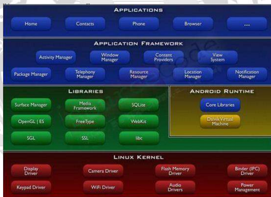
รูปที่ 2.1 โครงสร้างการทำงานของแอนดรอยด์
