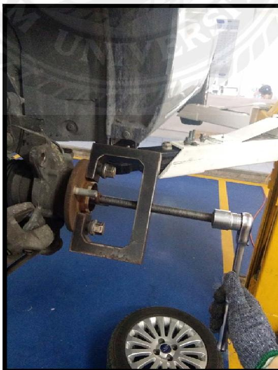
10. ข้อสังเกต : ตรวจสอบให้แน่ใจว่าสตรัทไม่เคลื่อนที่เกินกว่าที่จำเป็นเพื่อไม่ให้เกิดความเสียหายต่อแฉวยรองด้านบน
