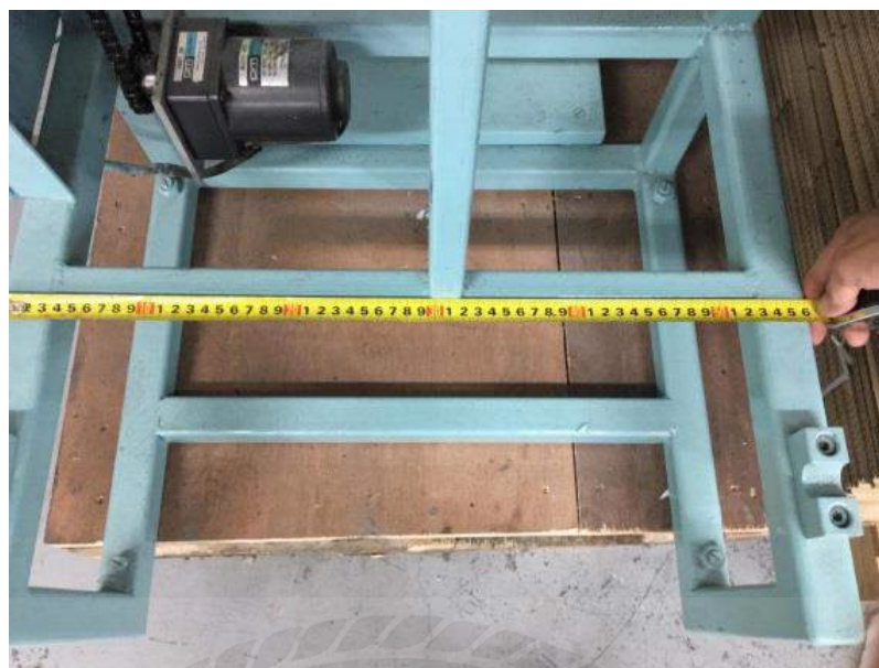
รูปที่ 3.14 เหล็กสี่เหลี่ยมยาว 50 ซม.
