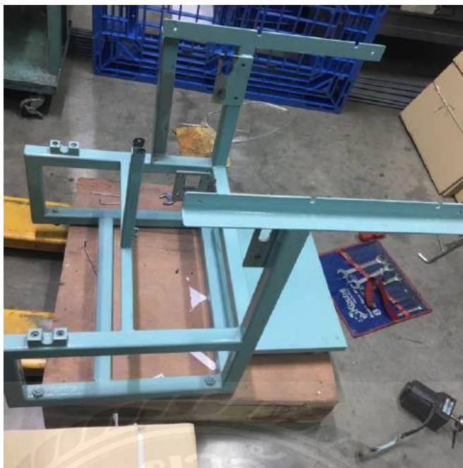
รูปที่ 3.18 ชิ้นส่วนทั้งหมดเชื่อมต่อกันเรียบร้อยแล้ว
