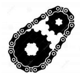
รูปที่ 2.5 เฟืองขับและเฟืองตรงโซ่ทำมุมเอียงไม่ควรมากกว่า 60 องศา จากแนวนอน
