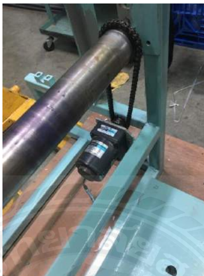
รูปที่ 3.20 ติดตั้งมอเตอร์ไฟฟ้า
