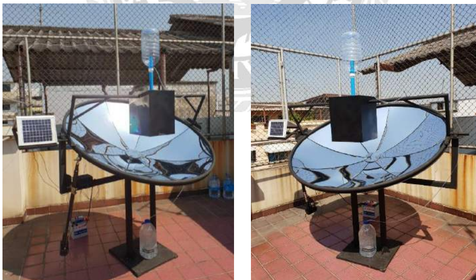
รูปที่ 3.20 เครื่องกลั่นน้ำทะเลด้วยพลังงานแสงอาทิตย์จากจานรับแสงพาราโบลาที่ติดตั้งเรียบร้อย
