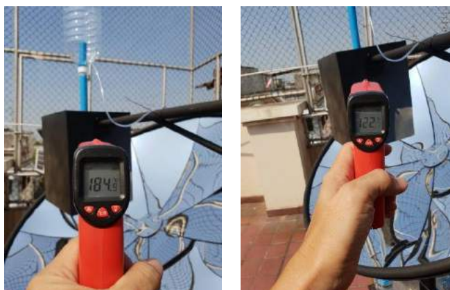
รูปที่ 3.22 วัดค่าอุณหภูมิที่หม้อต้มขณะทำการทดสอบ
