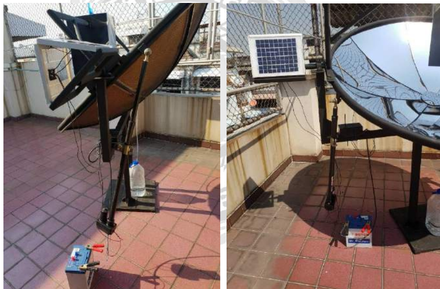
รูปที่ 3.18 การติดตั้งชุดขับเคลื่อนมอเตอร์ (Actuator Motor)
