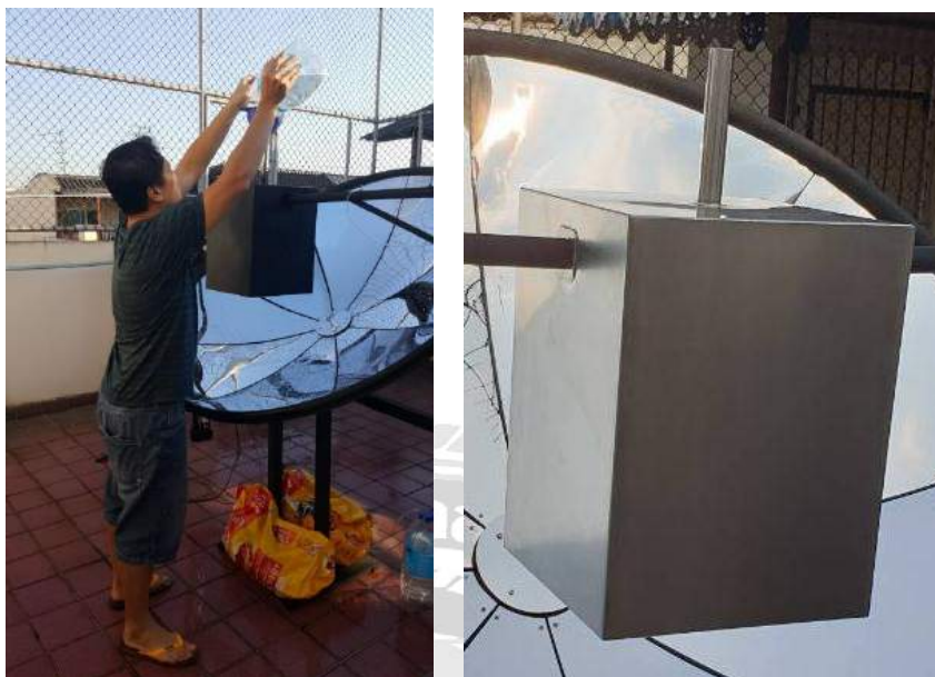
รูปที่ 3.21 การเติมตัวอย่างน้ำทะเลที่จะทดสอบลงในหม้อต้ม
