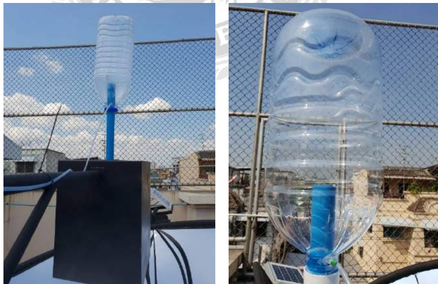
รูปที่ 3.7 บรรจุภัณฑ์ที่ใช้ทำเครื่องควบแน่น
