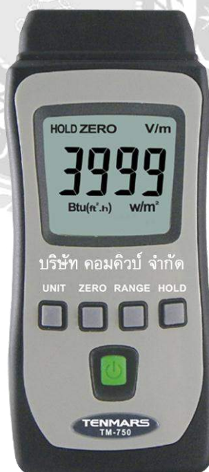
รูปที่ 3.11 เครื่องมือวัดค่าความเข้มแสงอาทิตย์
