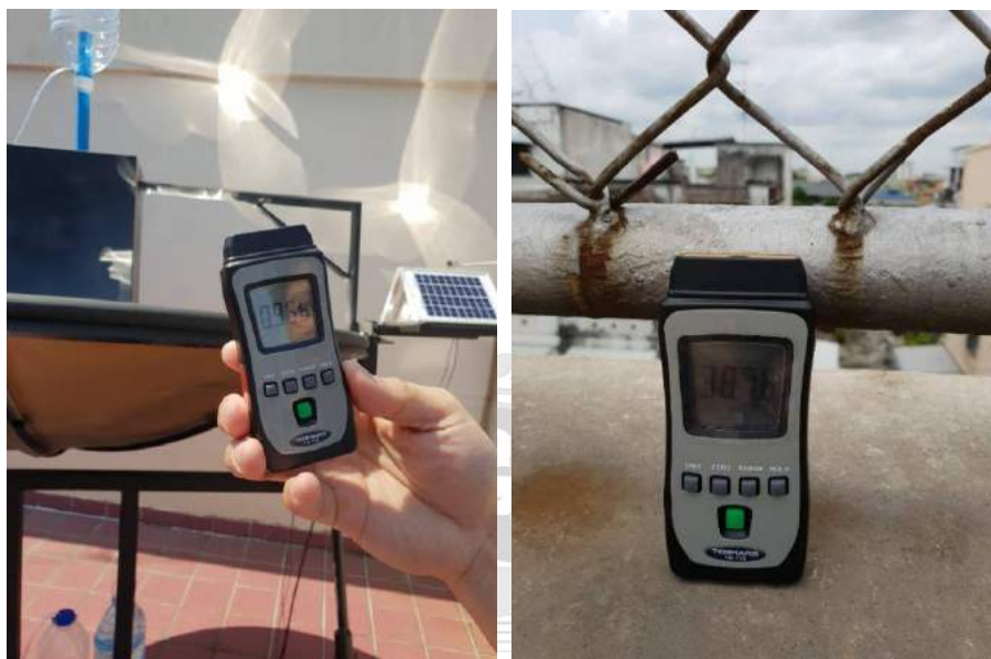
รูปที่ 3.23 วัดค่าความเข้มแสงดวงอาทิตย์ขณะทำการทดสอบ
