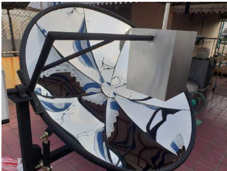
รูปที่ 3.15 การติดตั้งงานพาราโบลา และหม้อต้มน้ำ
