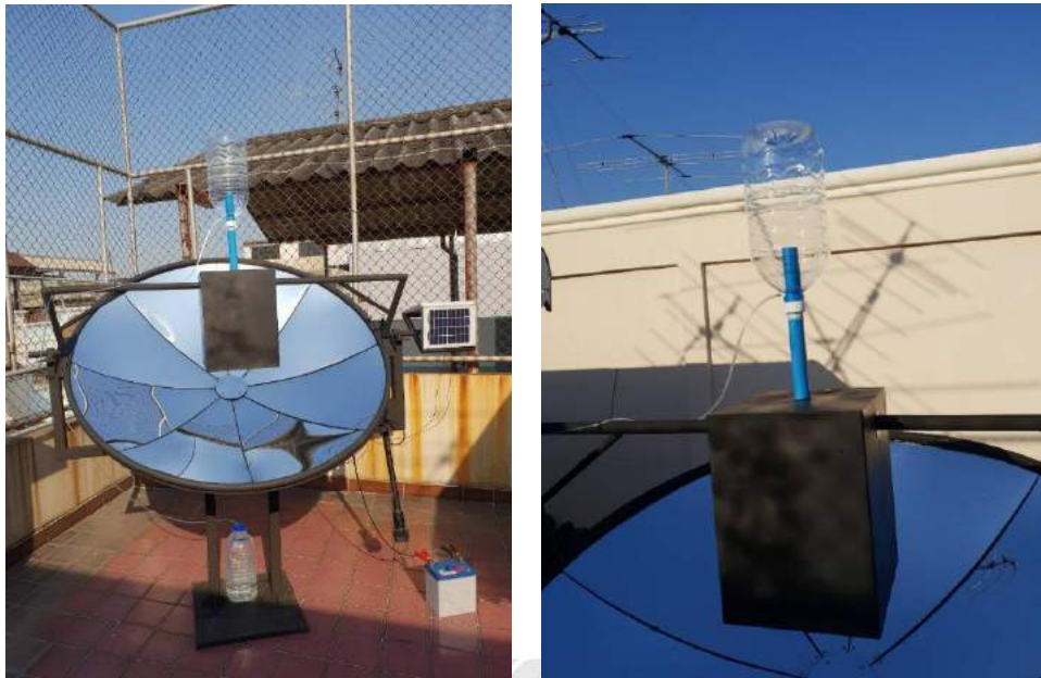
รูปที่ 3.19 การติดตั้งชุดควบคุมแน่น และภาชนะเก็บน้ำกลั่น
