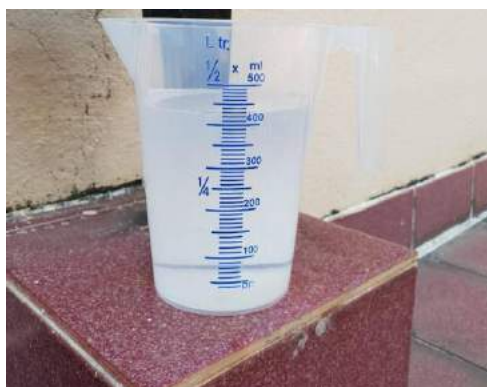
รูปที่ 3.24 วัดปริมาณน้ำที่กลั่นได้ และปริมาณน้ำทะเลที่เหลือ ขณะทำการทดสอบ
