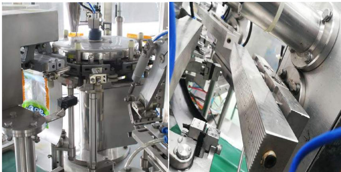
รูปที่ 3.13 การทำงานโดยการปิดผนึกปากถุง
