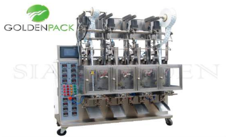
รูปที่ 2.4 เครื่องบรรจุซองสตีก 4 หัวบรรจุทรงตั้ง
