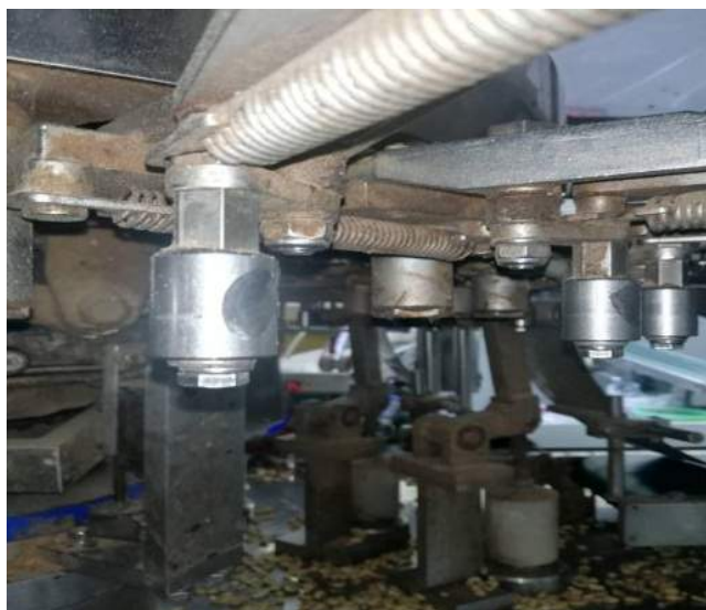
รูปที่ 3.15 กราบผงกาแฟที่เข้าไปอุดตันภายใต้เครื่องทำให้เกิดการทำงานที่ล่าช้า และทำให้อุปกรณ์บางส่วนเกิดการอุดตันของกราบผงกาแฟ
