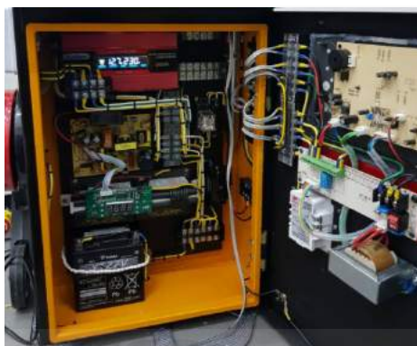
รูปที่ 3.27 เก็บรายละเอียดการออกแบบอุปกรณ์ตรวจจับและแจ้งเตือนเหตุเพลิงไหม้แบบเคลื่อนที่ (การทดสอบวงจรการทำงานของระบบ)
