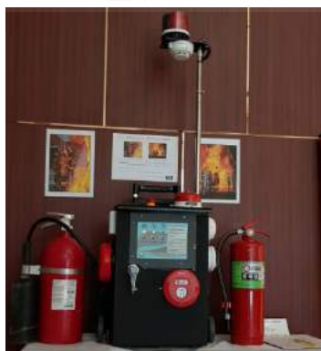
รูปที่ 3.29 เก็บรายละเอียดการออกแบบอุปกรณ์ตรวจจับและแจ้งเตือนเหตุเพลิงไหม้แบบเคลื่อนที่ (พร้อมใช้งาน)
