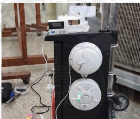
รูปภาพที่ 4.7 ทดสอบการตรวจจับ (Heat Detector) ดำเนินการทดสอบที่อุณหภูมิสิ่งแวดล้อม 31.9^{\circ}\text{C}
