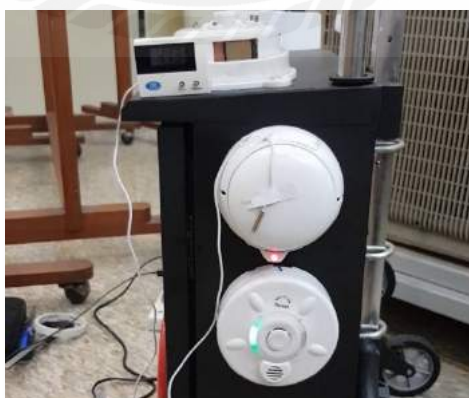
รูปภาพที่ 4.8 ทดสอบการระยะเวลาในตรวจจับความร้อน (Heat Detector) ที่ผลต่างของอุณหภูมิ 10^{\circ}\text{C}
