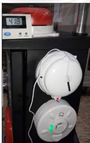
รูปภาพที่ 4.5 ทดสอบการตรวจจับความร้อน (Heat Detector) ที่ผลต่างของอุณหภูมิ 15°C
