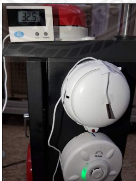
รูปภาพที่ 4.2 ทดสอบการตรวจจับความร้อน (Heat Detector) ที่อุณหภูมิสิ่งแวดล้อม 32.5°C
