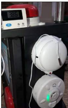
รูปภาพที่ 4.3 ทดสอบการตรวจจับความร้อน (Heat Detector) ที่ผลต่างของอุณหภูมิ 5°C
