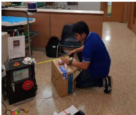
รูปภาพที่ 4.6 ทดสอบการตรวจจับ (Heat Detector) ใช้ระยะทางเพื่อหาผลต่างอุณหภูมิ 10^{\circ}\text{C}
