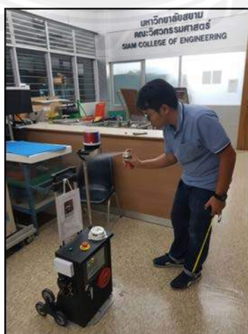
รูปภาพที่ 4.10 ทดสอบการตรวจจับควัน (Smoke Detector) ที่ระยะกเวลา 1 วินาที โดยใช้เครื่องมือวัดระยะทาง 30 cm
