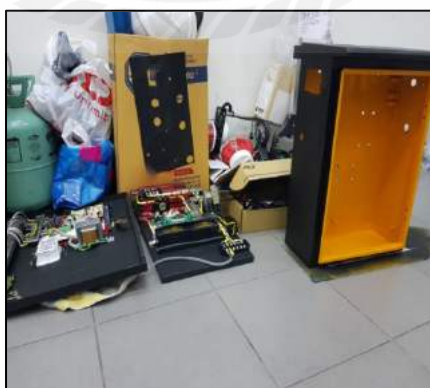
รูปที่ 3.26 เก็บรายละเอียดการออกแบบอุปกรณ์ตรวจจับและแจ้งเตือนเหตุเพลิงไหม้แบบเคลื่อนที่ (การแยกชุดของระบบ Fire Alarm ออกเป็น 3 ชุด เพื่อง่ายต่อการซ่อมแซม)
