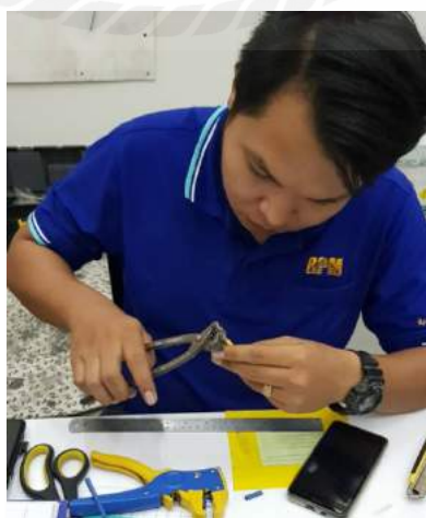
รูปที่ 3.12 การจัดทำชุดสายไฟฟ้าเพื่อเตรียมติดตั้งสายไฟฟ้าของวงจร
