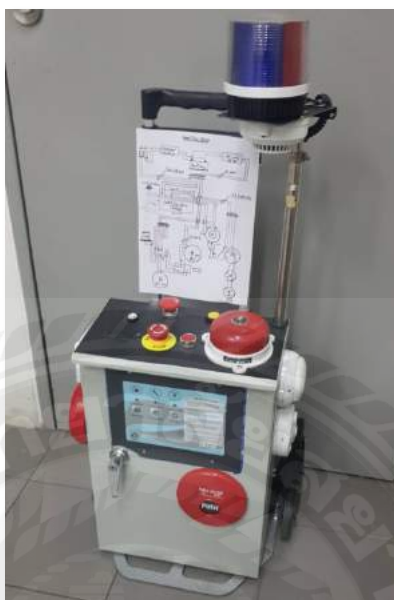
รูปที่ 3.22 อุปกรณ์ตรวจจับและแจ้งเตือนเหตุเพลิงไหม้แบบเคลื่อนที่ ก่อนการเก็บรายละเอียดชิ้นงาน
