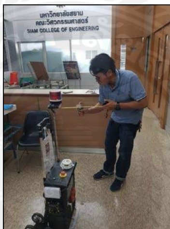
รูปภาพที่ 4.9 ทดสอบการตรวจจับควัน (Smoke Detector) โดยใช้เครื่องมือวัดระยะทาง
