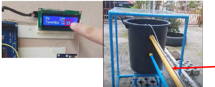
รูปที่ 4.3 การติดตั้งเซนเซอร์วัดอุณหภูมิในน้ำและอ่านค่าผ่านจอ LCD
