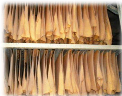
รูปที่ 2. กระบวนการผลิตแผ่นรมควัน
