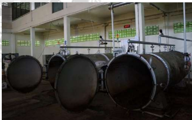
รูปที่ 3.9 นำสินค้าที่บรรจุปิดฝาเรียบร้อยแล้วเข้าหม้อรีเทอร์ทเพื่อสเตอริไรส์
