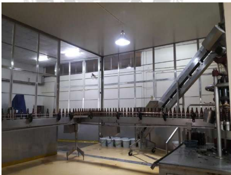
รูปที่ 3.7 ขวดแก้วที่ผ่านเครื่องล้างทำความสะอาดแล้วจะผ่านสายพานลำเลียงเข้า อุโมงค์ความร้อนเพื่อทำการพาสเจอร์ไรส์ก่อนการบรรจุสินค้า
