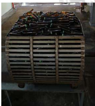
รูปที่ 3.9 นำสินค้าที่บรรจุปิดฝาเรียบร้อยแล้วเข้าหม้อรีเทอร์ทเพื่อสเตอริไรส์
