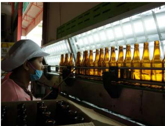
รูปที่ 4.10 พนักงานตรวจเช็คคุณภาพขวดแก้ว จะหยิบขวดแก้วที่เลอะ แตก/บิ่น ออกจากสายพาน
