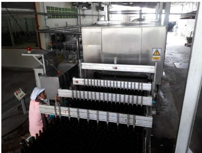
รูปที่ 3.6 เครื่องล้างขวดแก้วก่อนผ่านเข้ากระบวนการบรรจุสินค้า
