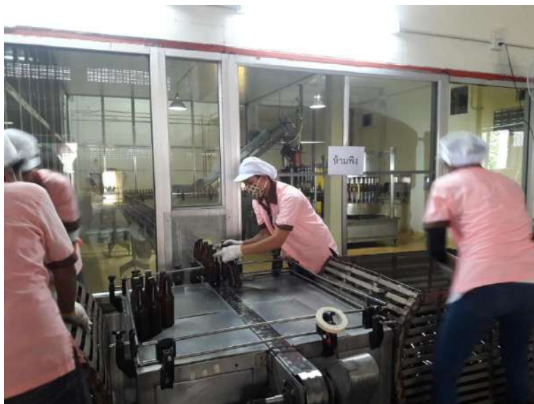
รูปที่ 3.8 พนักงานนำสินค้าที่บรรจุและปิดฝาแล้วลงตะแกรงเพื่อนำไปสเตอริไรส์
