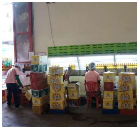
รูปที่ 4.10 พนักงานตรวจเช็คคุณภาพขวดแก้ว จะหยิบขวดแก้วที่เลอะ แตก/บิ่น ออกจากสายพาน
