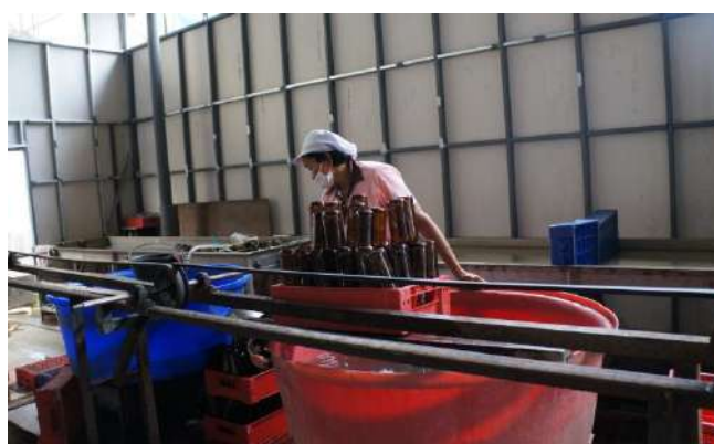
รูปที่ 3.5 ขวดแก้วเลอะนำมาปั่นแฉ่เพื่อทำความสะอาด
