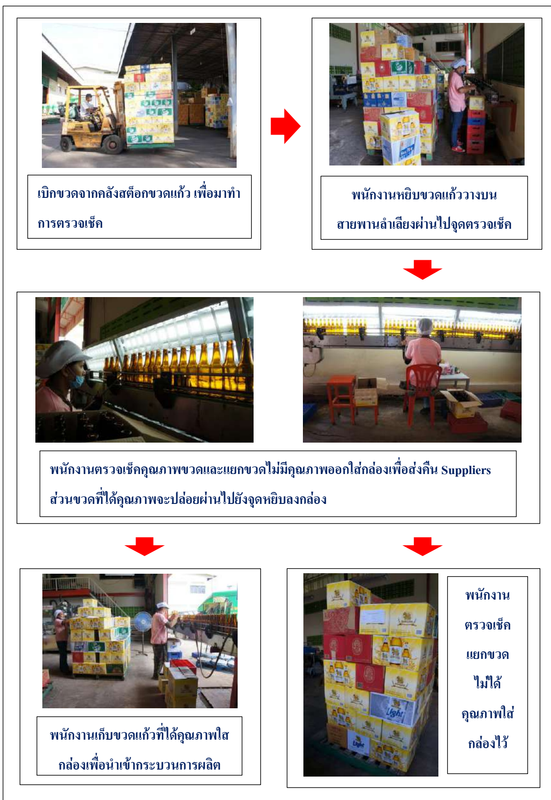
รูปที่ 4.14 รูปสรูปกระบวนการตรวจเช็คคุณภาพขวดแก้วก่อนนำเข้ากระบวนการบรรจุสินค้า
