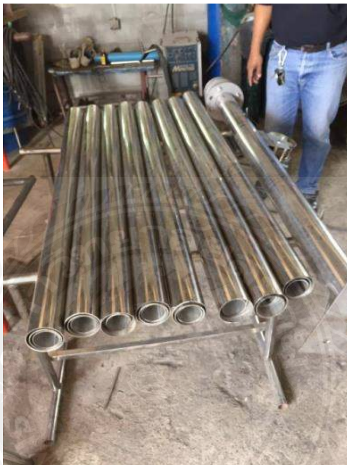
รูปที่ 4.12 รูปภาพการตัดท่อให้ได้ตามขนาด
