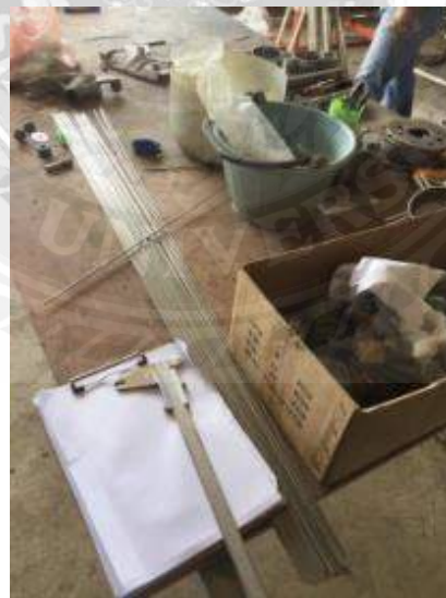
รูปที่ 4.14 รูปภาพลวดสแตนเลสสำหรับทำรางสลิง
