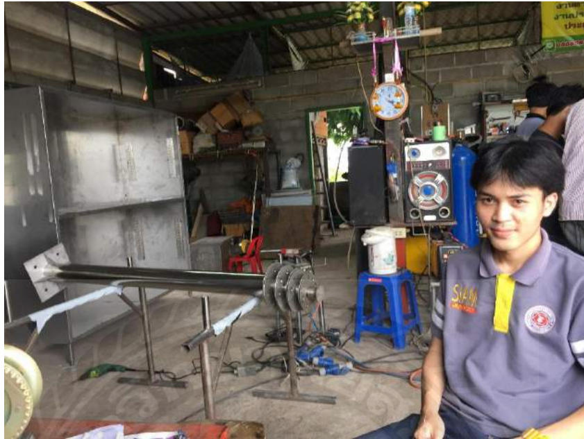
รูปที่ 4.13 รูปภาพการเชื่อมหน้าแปลนติดกับท่อ
