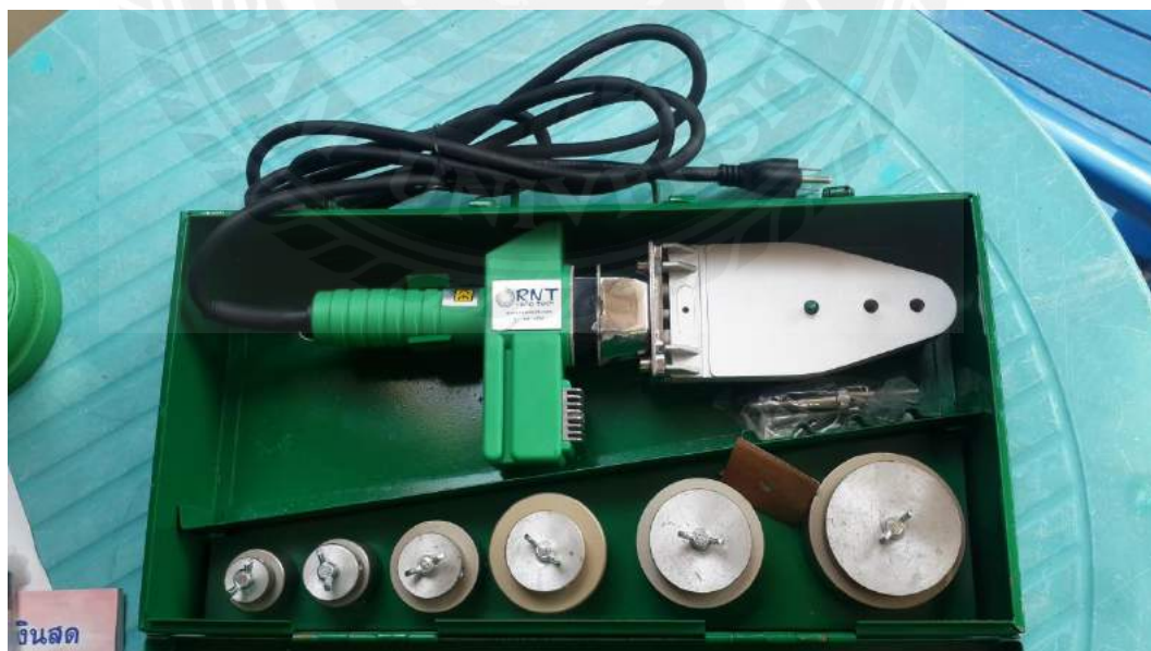
รูปที่ 3.17 เครื่องเชื่อมท่อพีพีอาร์
