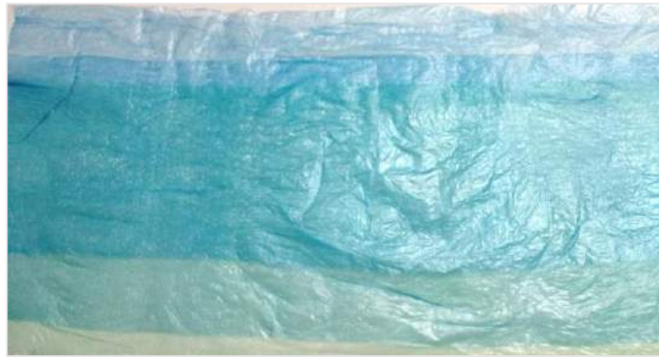
ภาพที่ 3.12 ตัวอย่างการต่อสีพลาสติกด้วยไฟระดับ B
