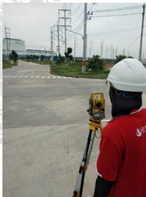
รูปที่ 4.2 ถ่ายค่าพิกัดหมุด BM → TP3
