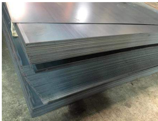
รูปที่ 3.4 เหล็กชุบสังกะสี 0.5 มิลลิเมตร K=75 W/MK
