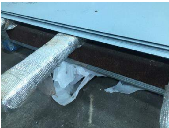
รูปที่ 3.7 เหล็กเคลือบสีคัลเลอร์บอนด์ 0.5 มิลลิเมตร. K=80 W/MK
