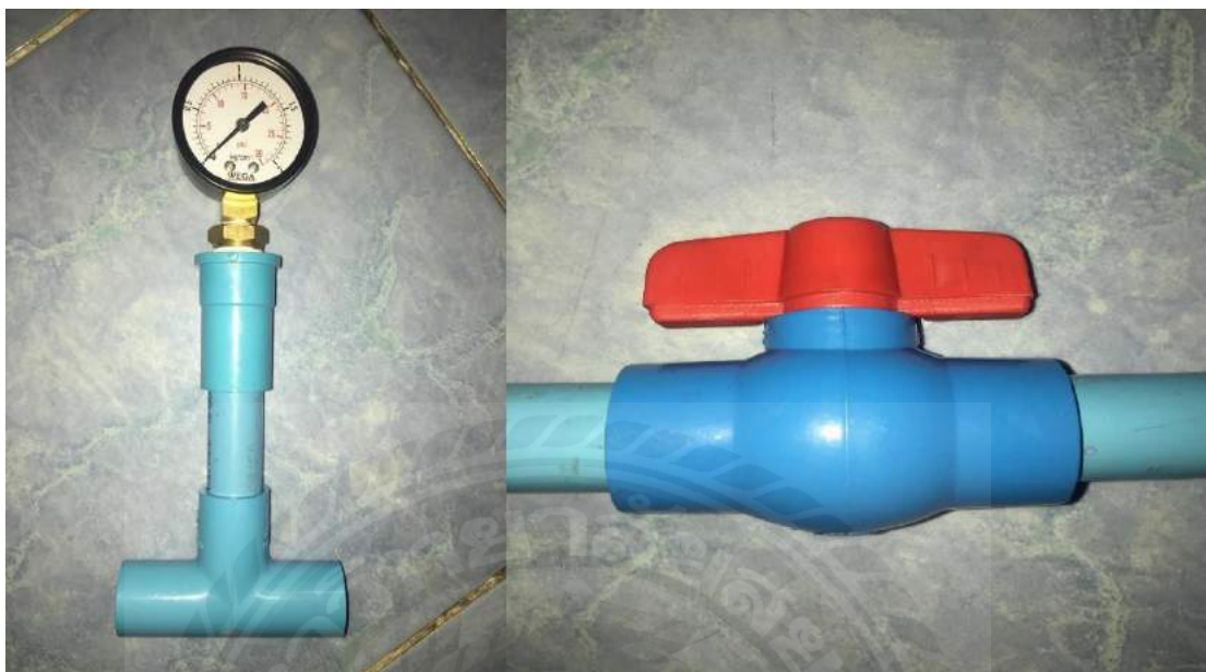
รูปที่ 3.22 บอลวาล์วข้อต่อตรงเกลียวในและท่อ PVC
