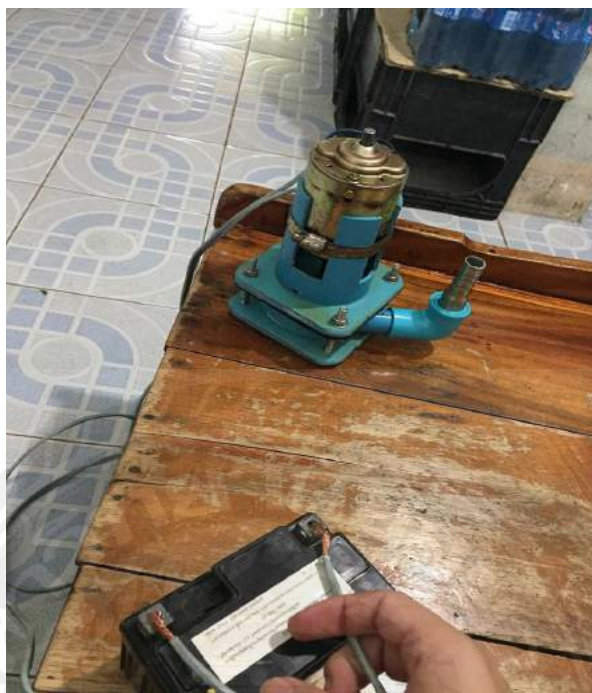
รูปที่ 3.11 ต่อสายไฟจากแบตเตอรี่ไปยังมอเตอร์พัดลมของเครื่องปรับอากาศ
