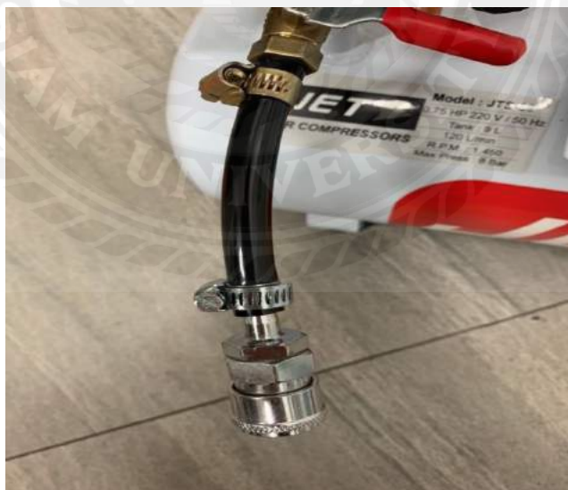
รูปที่ 3.8.1.10 ติดตั้งสายลมและคอปเปอร์
