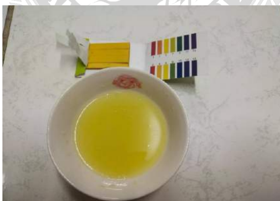
รูปที่ 4.7 น้ำมาแบ่งใส่ถ้วยเล็ก ๆ แล้วเตรียมกระดาษวัดค่า pH มาทดสอบ
