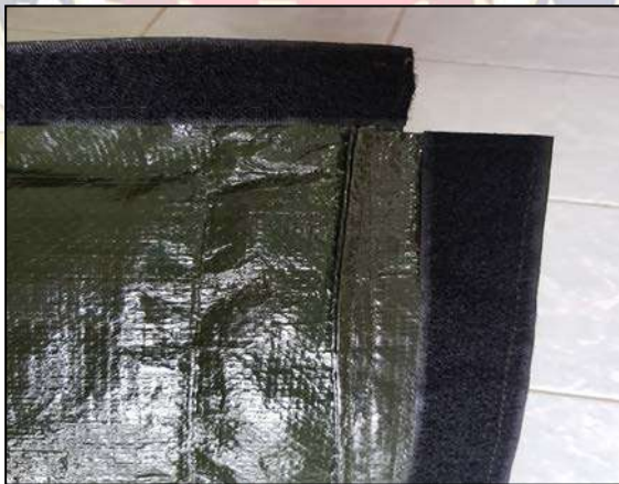
ภาพที่ 4.6 เย็บเทปหนามเตยติดกับผ้าใบตามรูปทรงของกล่อง
