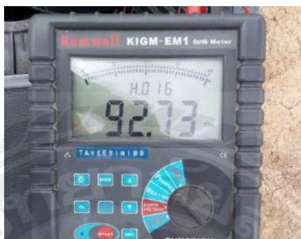
รูปที่ 3.4 ค่าที่ได้จากการทดสอบหาความต้านทานจำเพาะของดิน
