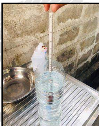
รูปภาพที่ 4.18 : หลังจากเทแอลกอฮอล์เสร็จแล้วให้รอจนน้ำนิ่ง และเริ่มใส่เครื่องมือไฮโดรมิเตอร์ลงไปอย่างช้าๆ ที่มา : ผู้จัดทำ ( 2563 )
