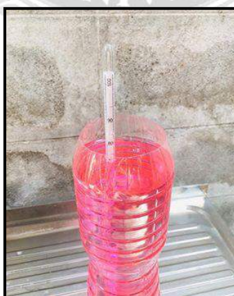
รูปภาพที่ 4.43 : ผลึกกันท์สเปรย์หอมปรับอากาศชิ้นนี้มีความเข้มข้นของแอลกอฮอล์อยู่ที่ 70 เปอร์เซ็นต์ ที่มา : ผู้จัดทำ ( 2563 )
