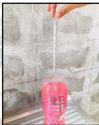
รูปภาพที่ 4.42 : หลังจากนั้นเริ่มใส่ไฮโดรมิเตอร์ลงไปอย่างช้าๆ และรอดูค่าความเข้มข้นของแอลกอฮอล์ ที่มา : ผู้จัดทำ ( 2563 )
