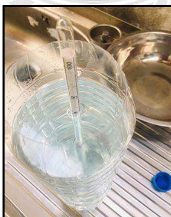
รูปภาพที่ 4.19 : หลังจากนั้นให้รอสักพักไฮโดรมิเตอร์จะลอยขึ้นมาตามความเข้มข้นของแอลกอฮอล์ ที่มา : ผู้จัดทำ ( 2563 )
