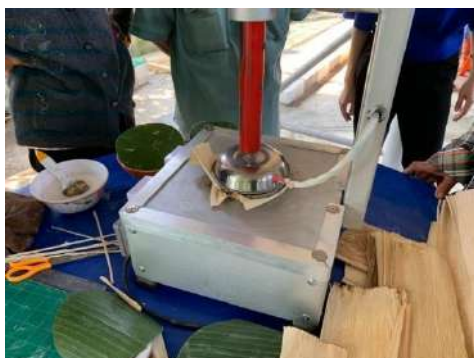
รูปที่ 4.14 อุปกรณ์ที่ใช้ในการผลิตชามกาบกล้วยจากกาบกล้วย
