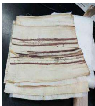
รูปที่ 4.9 นำกากกล้วยมาวางใจไว้กัน ทากาวแป้งเปียก
