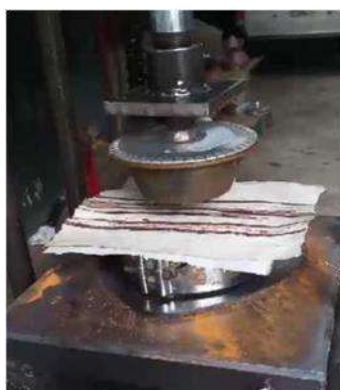
รูปที่ 4.18 วางบนเครื่องขึ้นรูป กดด้วยความร้อนประมาณ 2 นาที
