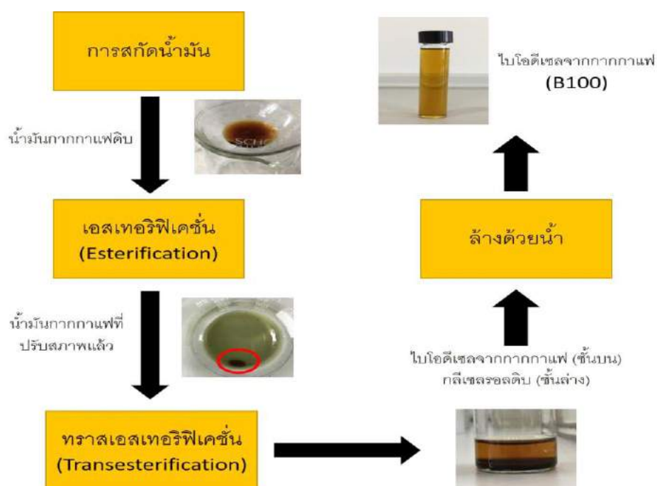
รูปที่ 2.2 กระบวนการผลิตไบโอดีเซลจากกากกาแฟ
