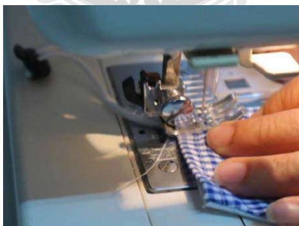
รูปที่ 4.18 เย็บยางคล้องหูติดให้กับตัวผ้า
