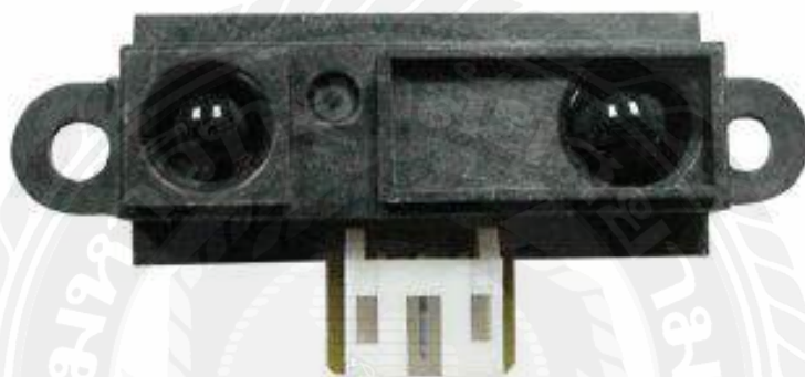
ภาพที่ 2-13 GP2D120 โมดูลตรวจจับระยะทางแบบอินฟราเรด
