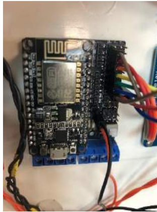
รูปที่ 4.1 การกำหนดพอร์ตของ ESP8266 NodeMCU
