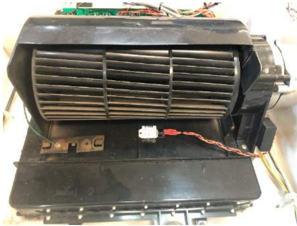
รูปที่ ก.3 การติดตั้งเซ็นเซอร์ DHT22 บริเวณที่ลมผ่าน
