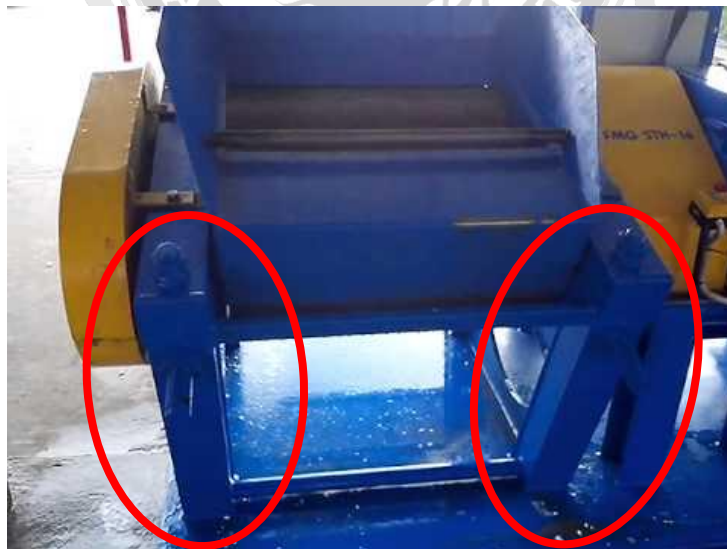
รูปที่ 4.1 เครื่องรีดยางเครปแบบเดิม ตรงส่วนขานี้มีลักษณะเอียง
