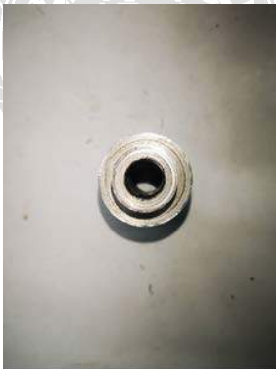
รูปที่ 3.25 กลึงได้ขนาดรอเชื่อมกับด้านซ้ายของแกนกลาง
