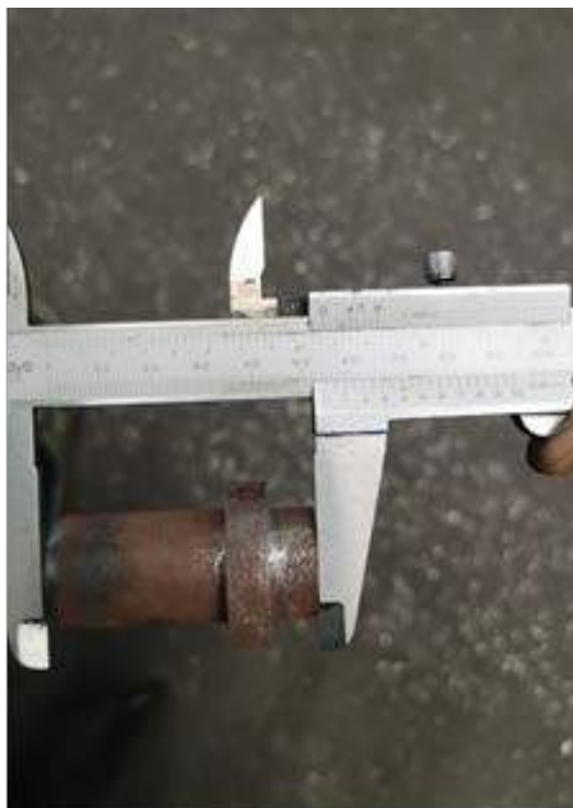
รูปที่ 3.24 กลึงเหล็กกลมตามขนาด
