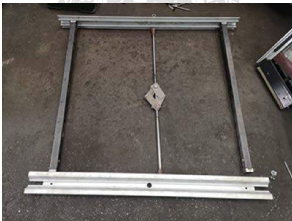
รูปที่ 3.61 การประกอบเหล็กป้อนเข้ากับแกนกลาง
