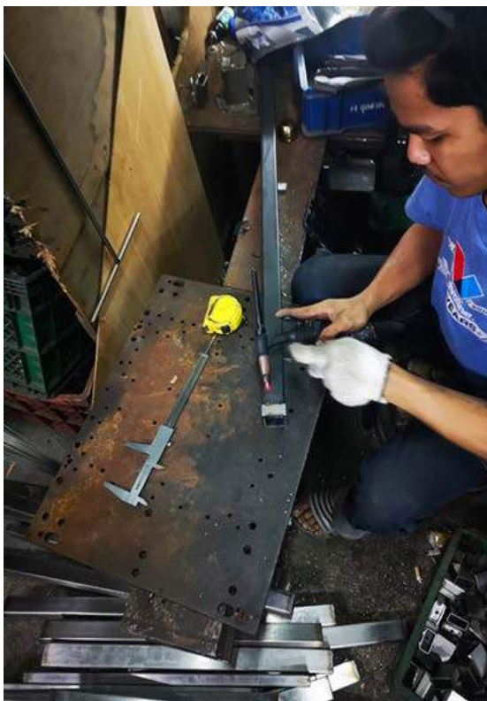
รูปที่ 3.8 เชื่อมปิดแผ่นเหล็กกล่องตามขนาด
