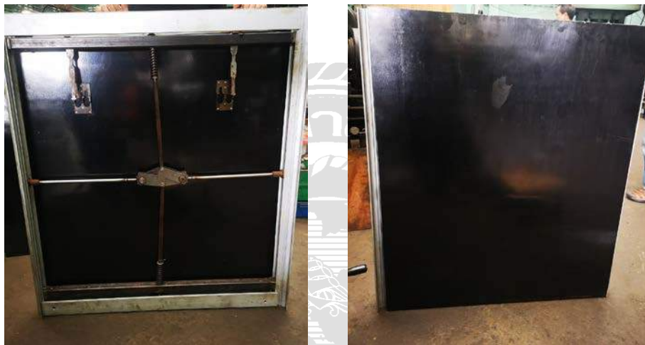
รูปที่ 40 ด้านในและด้านนอกของบานเลื่อนเก็บเสียง
