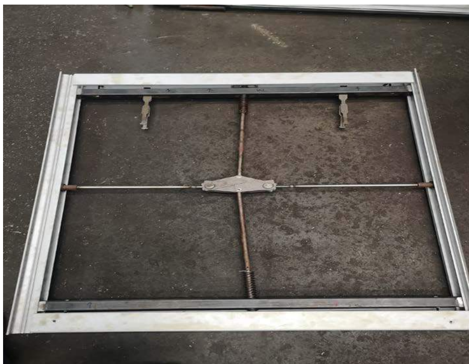
รูปที่ 3.66 ประกอบตัวยึดระหว่างโครงบานเลื่อนกับแผ่นไม้
