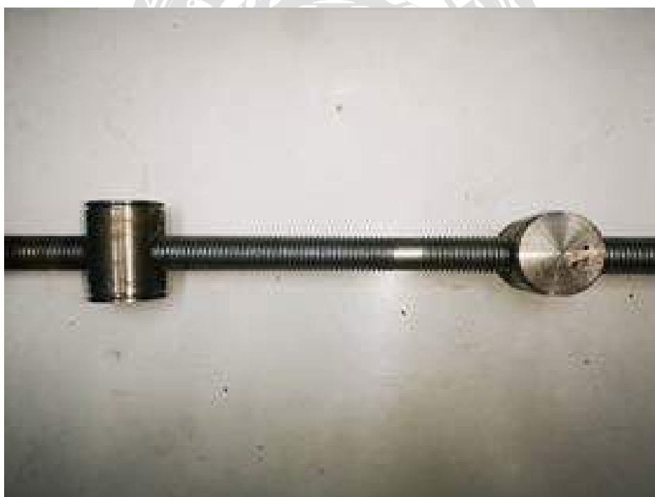
รูปที่ 3.35 ประกอบแกนกลางเข้ากับเหล็กกลิ้งที่วัดขนาดมา
