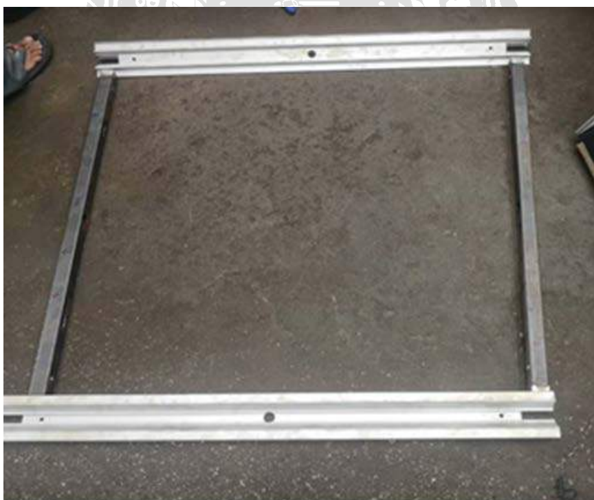
รูปที่ 3.59 ประกอบอลูมิเนียมและเหล็กกล่อง
