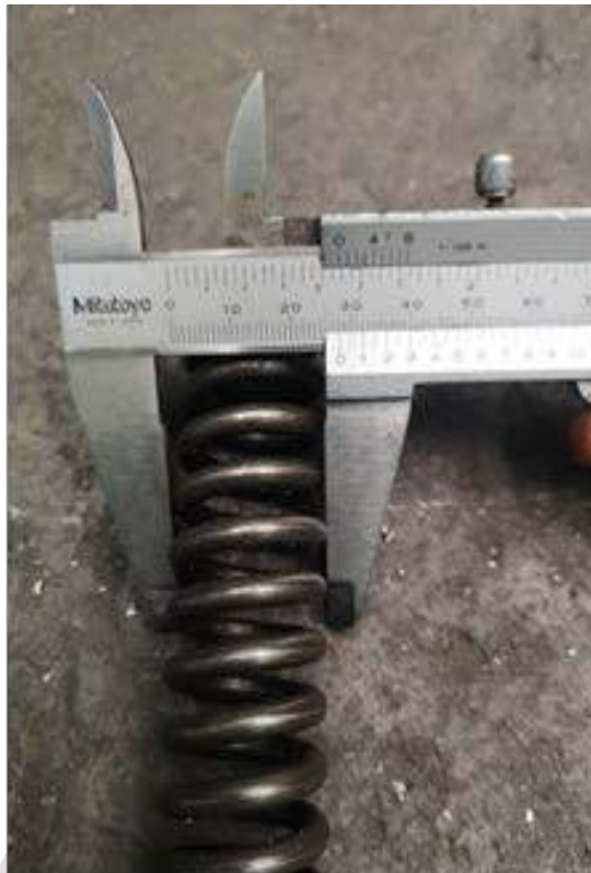
รูปที่ 3.50 สปริงที่ใช้ยกด้านบน,ล่างเพื่อเก็บเสียงได้อย่างมีประสิทธิภาพมากขึ้น
