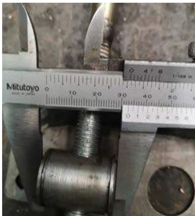
รูปที่ 3.34 วัดขนาดของเหล็กกลิ้งกลมตามขนาดที่เขียนแบบ
