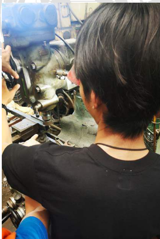
รูปที่ 3.11 ใช้เครื่องปาดส่วนเกินจากรอยเชื่อมออก
