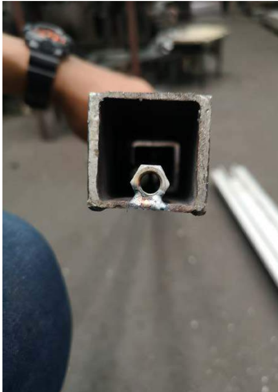
รูปที่ 3.14 น็อตตัวเมียเชื่อมติดเหล็กกล่อง
