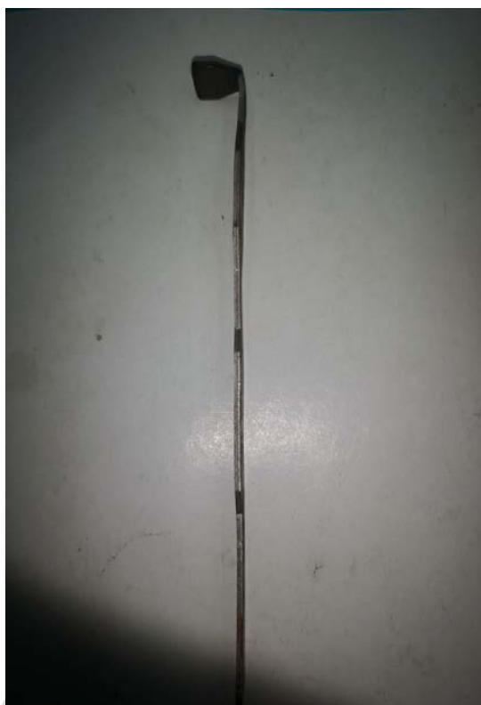
รูปที่ 3.52 เหล็กปั๊มขึ้นรูปที่ใช้ยึดไม้กับบานเลื่อน
