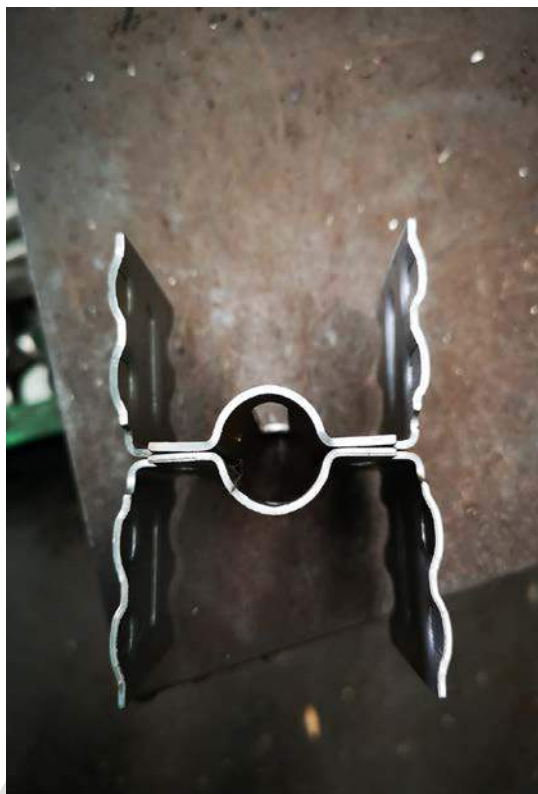
รูปที่ 3.42 เมื่อเชื่อมติดเหล็กปั๊มอย่างสมบูรณ์
