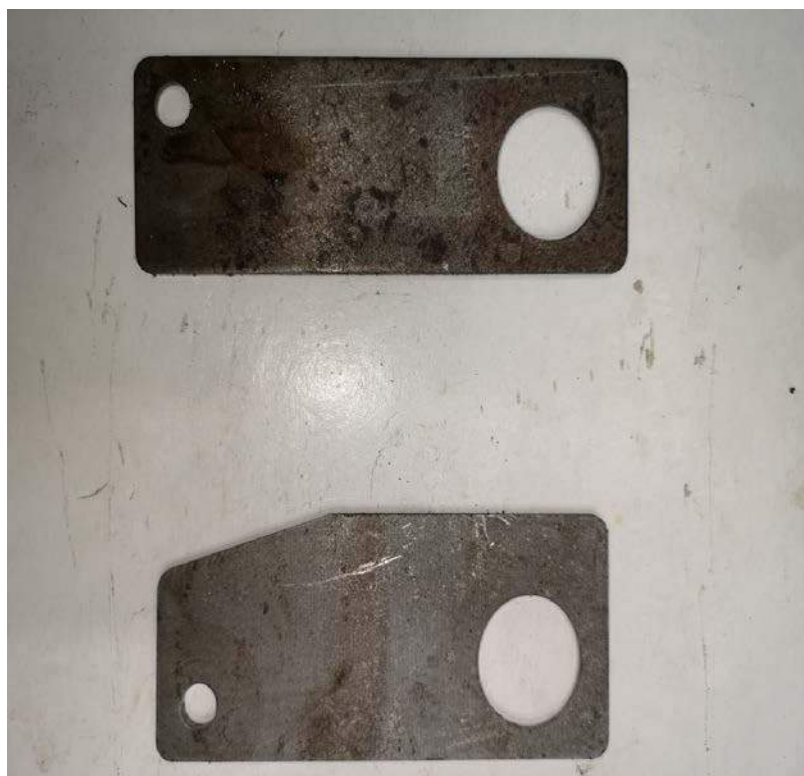
รูปที่ 3.32 แผ่นเหล็กปั๊มที่สมบูรณ์
