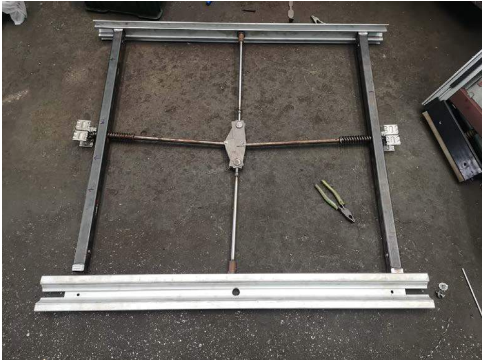
รูปที่ 3.64 ประกอบแผ่นเหล็กปั๊มขึ้นรูปให้ยึดติดกับเหล็กกลมและสปริง
