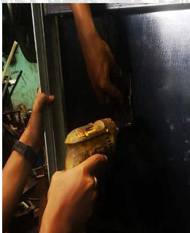
รูปที่ 3.57 การยิงนอตยึดแผ่นเหล็กปั๊มขึ้นรูปกับไม้
