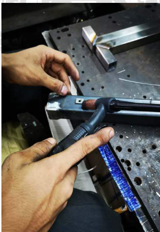
รูปที่ 3.13 แผ่นเกลียวเชื่อมติดเหล็กกล่อง
