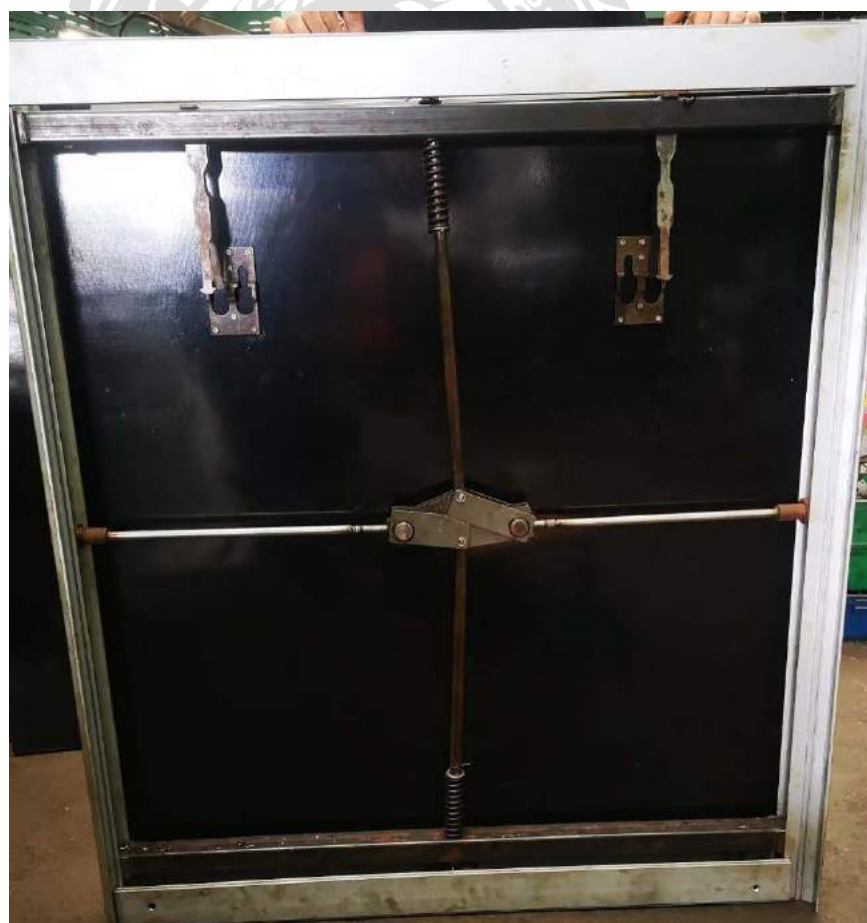
รูปที่ 3.67 นำแผ่นไม้มาติดกับตัวโครงบานเลื่อน
