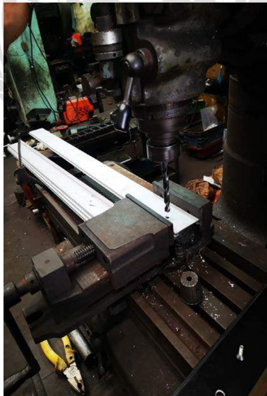
รูปที่ 3.15 นำอลูมิเนียมที่รีดออกมาเจาะ
