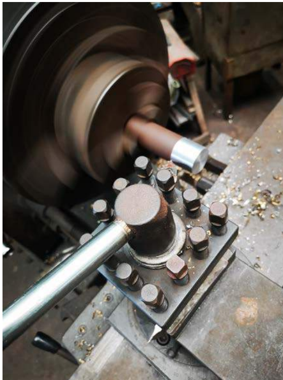
รูปที่ 3.26 กลึงเหล็กกลมด้านไข
