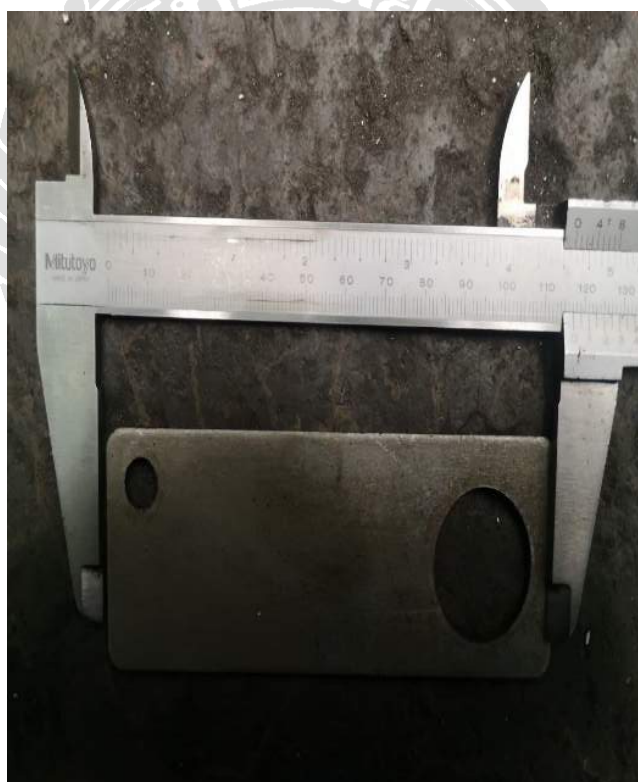
รูปที่ 3.31 นำแผ่นเหล็กที่ออกมาจากเครื่องปั๊มมาวัดขนาด
