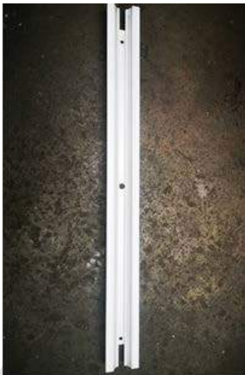
รูปที่ 3.18 อลูมิเนียมที่เจาะรูเสร็จทุกจุด
