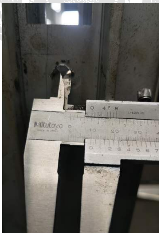
รูปที่ 3.17 รูเจาะขนาด 10 mm.
