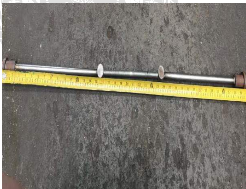
รูปที่ 3.37 นำเหล็กกลึงมาประกอบฝังซ้าย,ขวา
