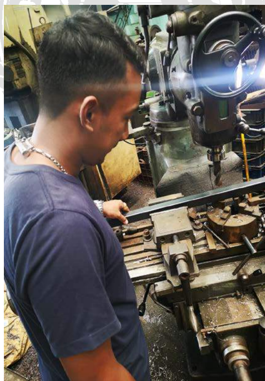
รูปที่ 3.9 เจาะรูกลางเหล็กกล่อง
