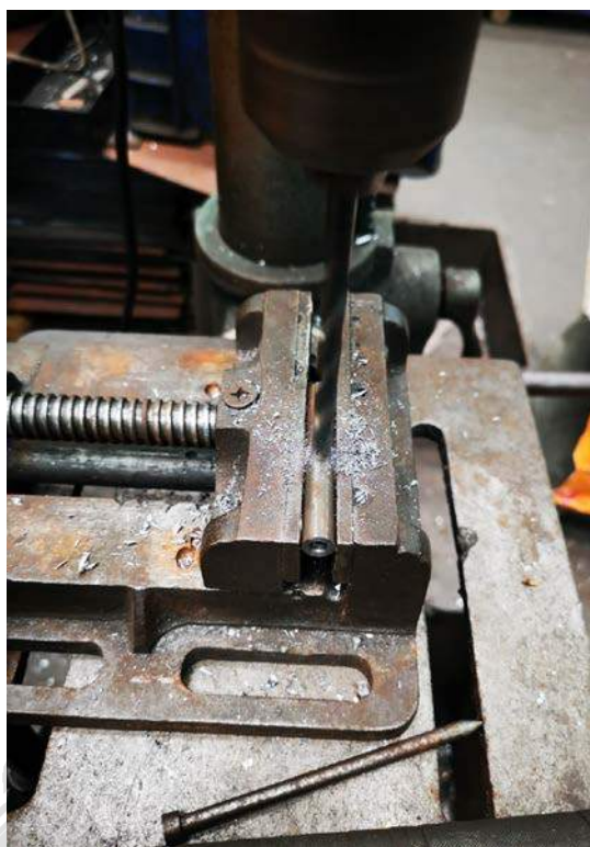
รูปที่ 3.44 เจาะรูแกนกลางเพื่อปรับตั้งความสูงต่ำของยางเก็บเสียง
