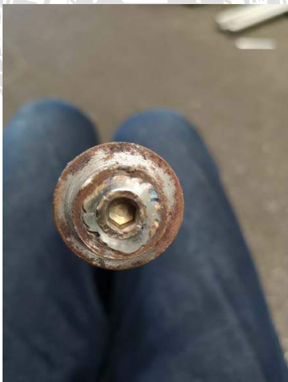
รูปที่ 3.29 นำเหล็กกลมด้านขวาที่กิ่งได้ขนาดมาเชื่อมติดกับนอตหกเหลี่ยมให้เป็นด้านซ้ายของบานเก็บเสียง
