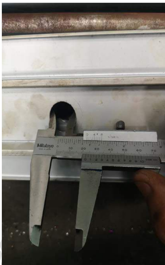
รูปที่ 3.16 รูเจาะขนาด 22 mm.
