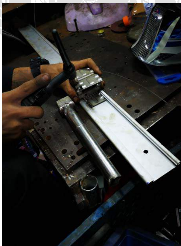
รูปที่ 3.41 ประกอบเหล็กปั๊มขึ้นรูปเข้าหากันโดยการเชื่อม
