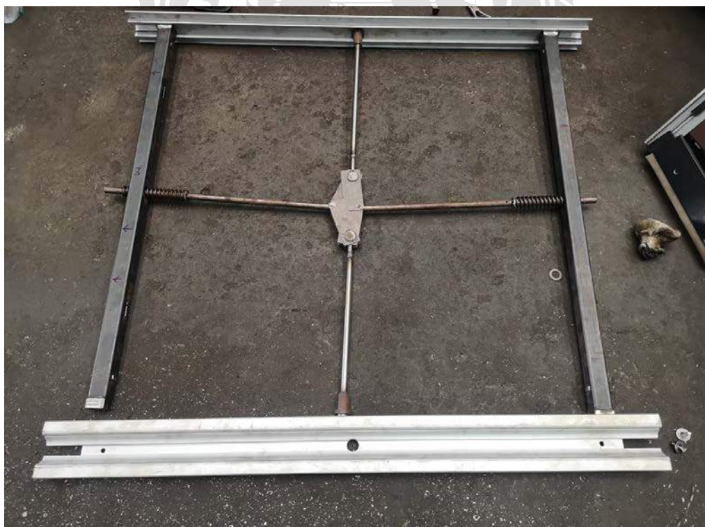
รูปที่ 3.63 ประกอบสปริงกับเหล็กกลมให้ติดกับรูกลางของเหล็กกล่อง
