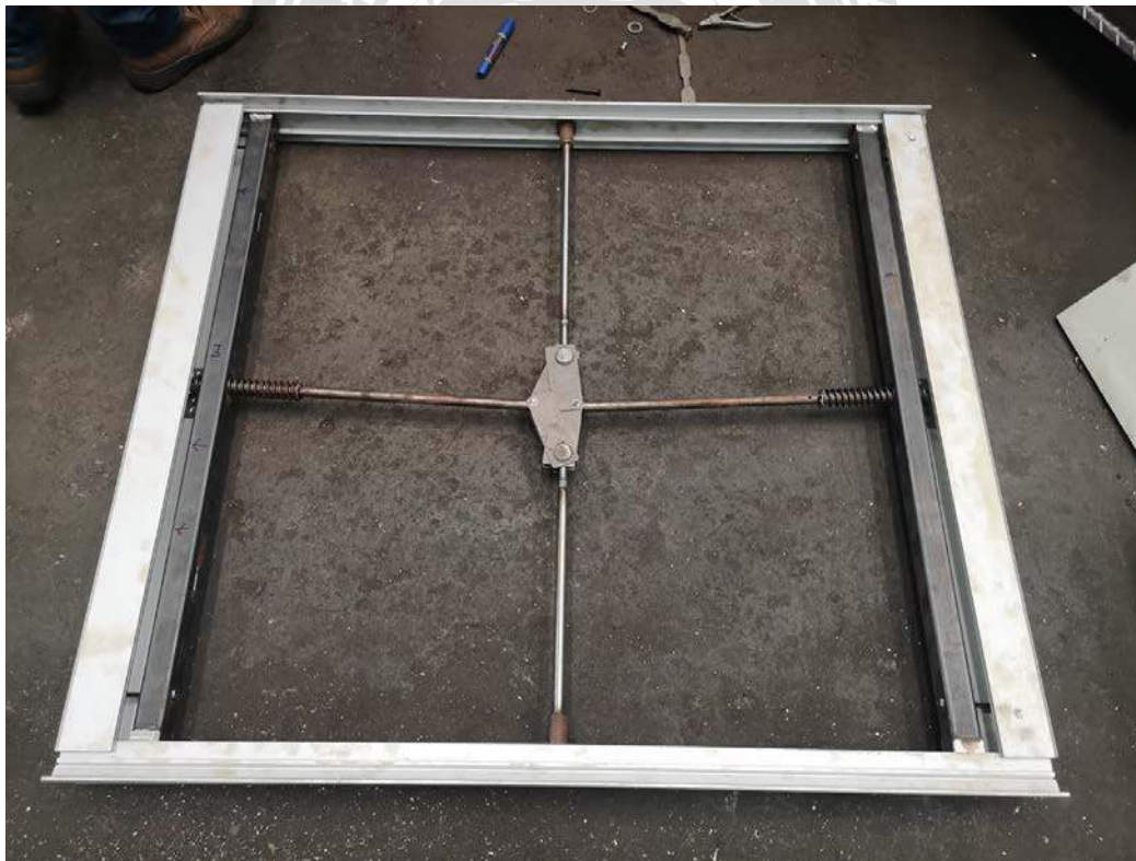
รูปที่ 3.65 ประกอบแผ่นอลูมิเนียมเข้ากับแผ่นเหล็กปั๊มขึ้นรูปด้านบน
