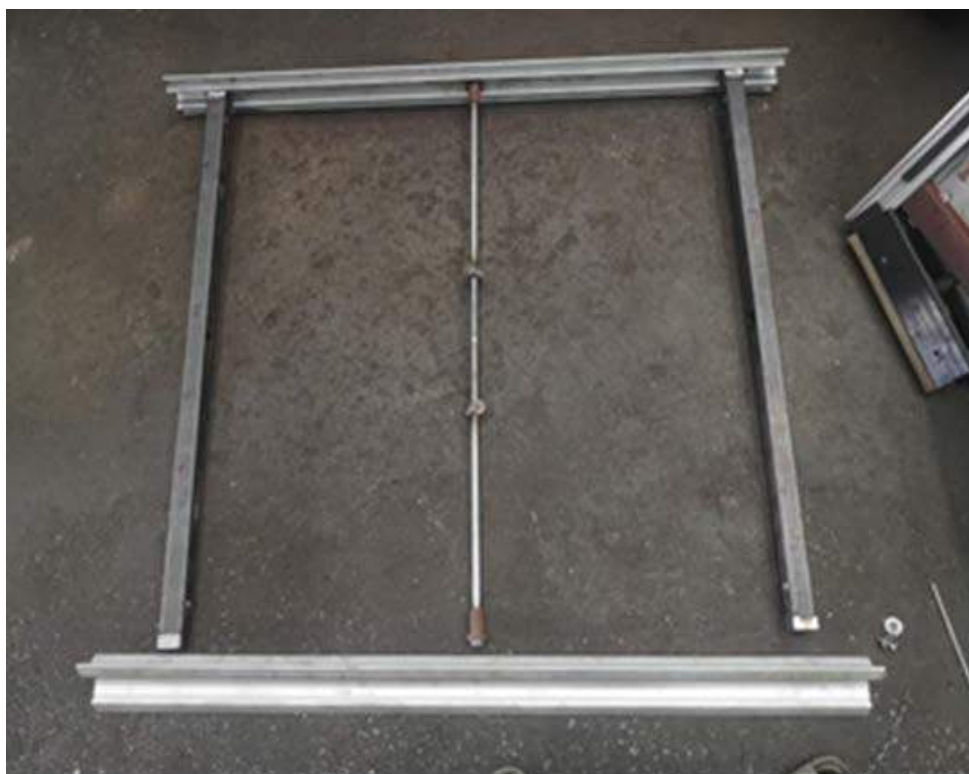
รูปที่ 3.60 ประกอบแกนกลางเข้ากับชิ้นงาน
