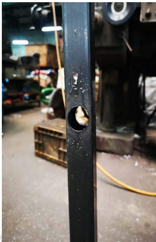
รูปที่ 3.10 เจาะรูกลางเหล็กกล่อง
