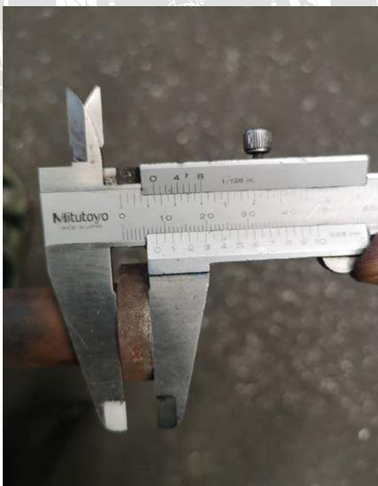
รูปที่ 3.23 การกลึงเหล็กและวัดขนาด
