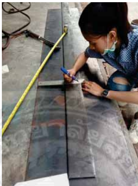
รูปที่ 3.6 แสดงการวัดและการมาร์คขนาดเหล็กที่จะตัด
