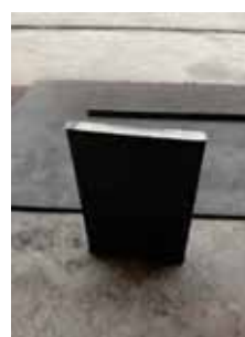
รูปที่ 3.7 แสดงการตัดเหล็กทำแท่นรองรับสปริง
