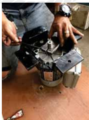
รูปที่ 3.25 แสดงการติดตั้งลูกเบี้ยวกับมอเตอร์
