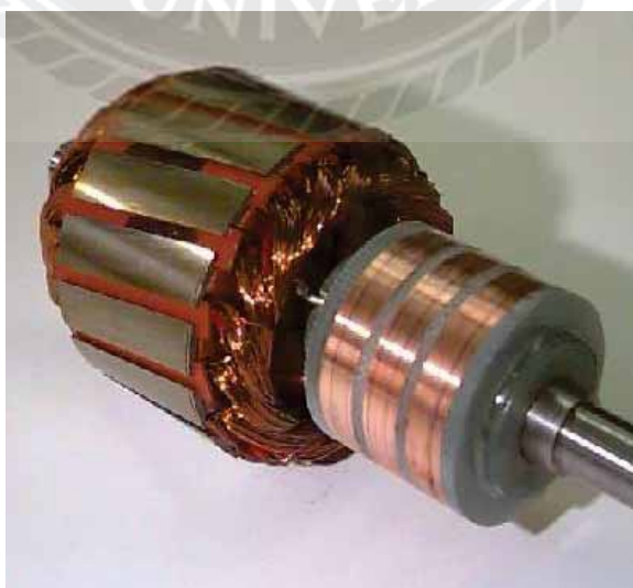
รูปที่ 2.19 ลักษณะของโรเตอร์แบบวาวด์โรเตอร์
