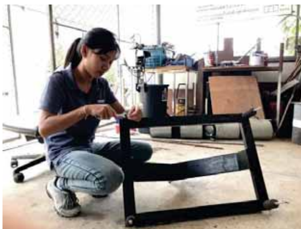
รูปที่ 3.18 แสดงการติดตั้งสปริง
