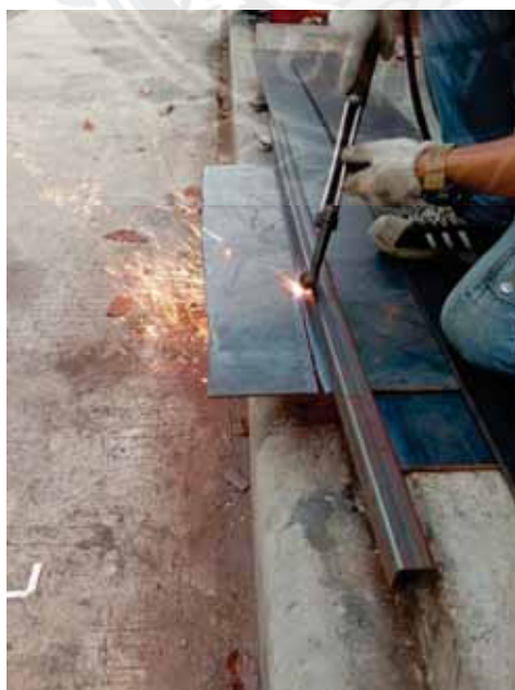
รูปที่ 3.7 แสดงการตัดเหล็กทำแท่นรองรับสปริง
