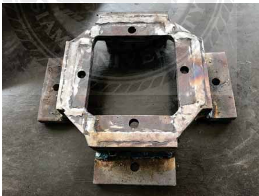
รูปที่ 3.15 หน้าแปลนที่เชื่อมประกอบแล้ว
