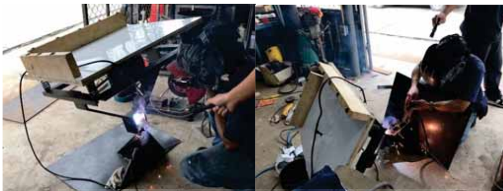
รูปที่ 3.35 แสดงการเชื่อมฐานของเครื่องกับแท่นของเครื่อง
