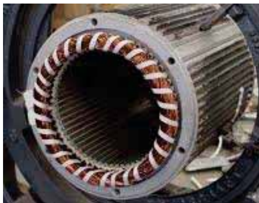
รูปที่ 2.21 ลักษณะแกนสเตเตอร์และขดลวดสเตเตอร์ของมอเตอร์เหนียวนำ 3 เฟส
