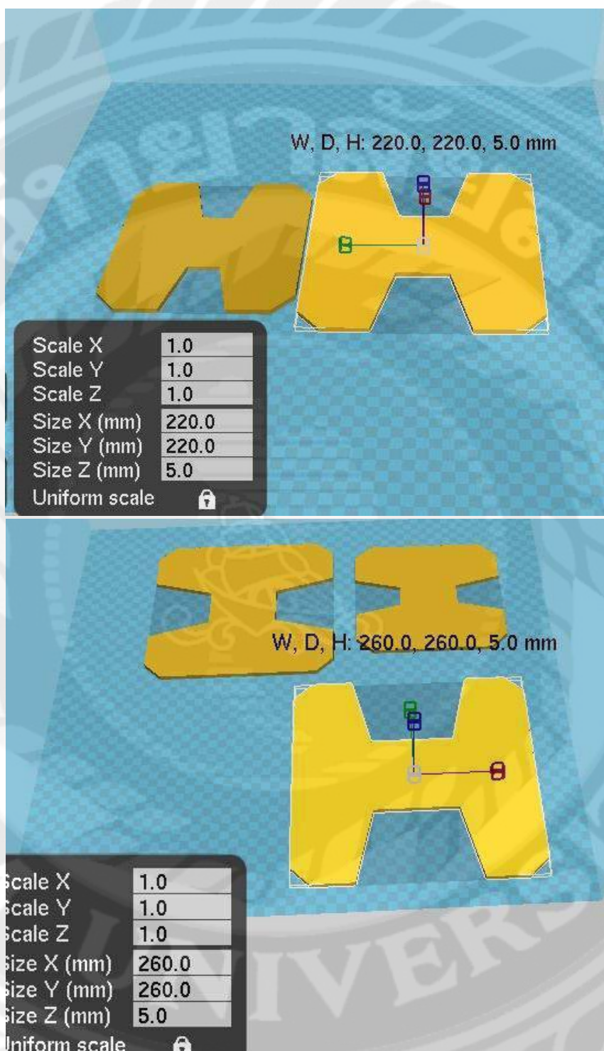
รูปที่ 3.6 การเตรียมไฟล์ G-Code สำหรับการพิมพ์
