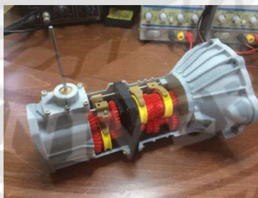
รูปที่ 2.17 ส่วนประกอบของเครื่องยนต์เกียร์ Manual ใช้ประกอบการสอนนักเรียน
