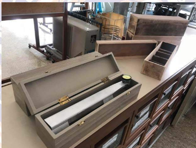
รูปที่ 5.2 กล่องบรรจุภัณฑ์ไม้สามารถรองรับได้พอดีกับสรีระของอุปกรณ์
