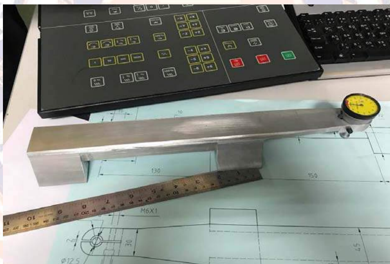
รูปที่ 3.1 การวัดขนาดเครื่องมือเพื่อทำการออกแบบชิ้นงานกล่องบรรจุภัณฑ์ไม้
