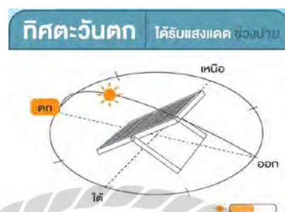
รูปที่ 2.22 การติดตั้งโซล่าเซลล์หันหน้าไปทางทิศตะวันตก
