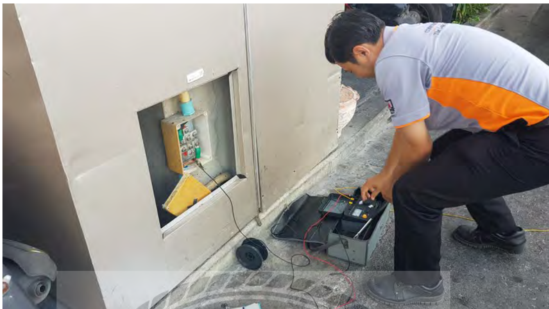
รูปที่ 6.23 การปฏิบัติงานทดสอบโดยเครื่อง Earth Ground Tester เข้ากับระบบสายดิน
