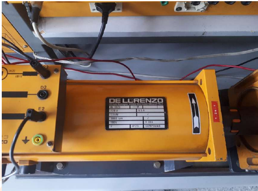
รูปที่ 4.3 มอเตอร์ไฟฟ้ากระแสตรงชนิดแยกกระตุ้น
