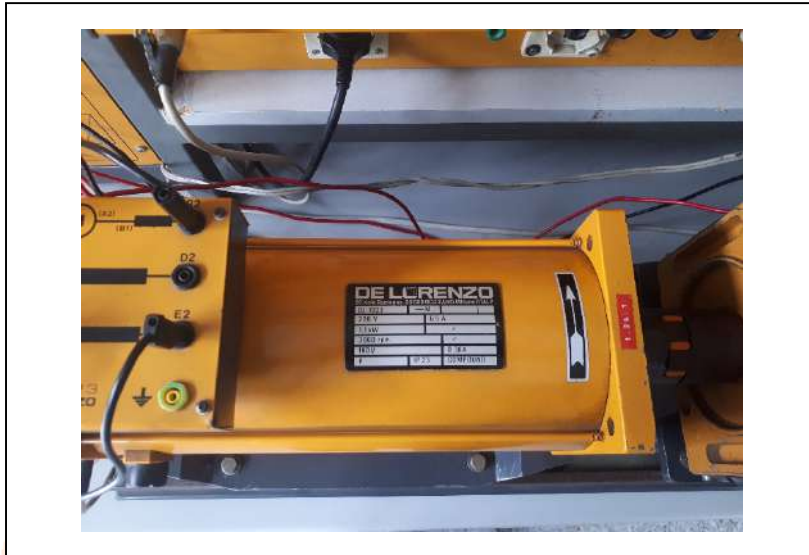
รูปที่ 0.21 มอเตอร์ไฟฟ้ากระแสตรงชนิดแยกกระตุ้นที่ใช้ในงานวิจัย
