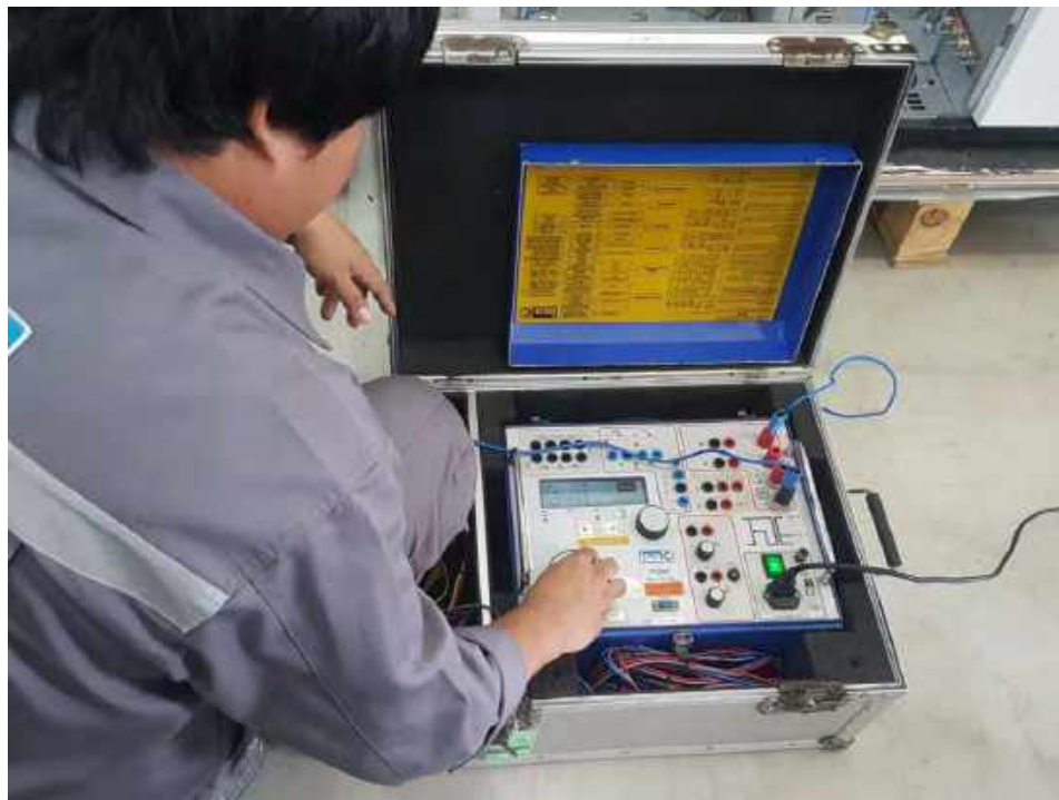
รูปที่ 4.4 ตรวจสอบระบบไฟของตู้สวิตช์เกียร์
