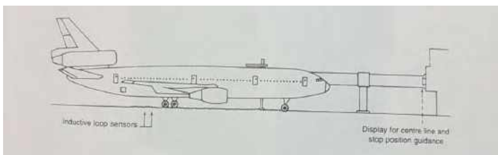
รูปที่ 2.24 A ลักษณะทั่วไปของการติดตั้ง Loop Sensor
