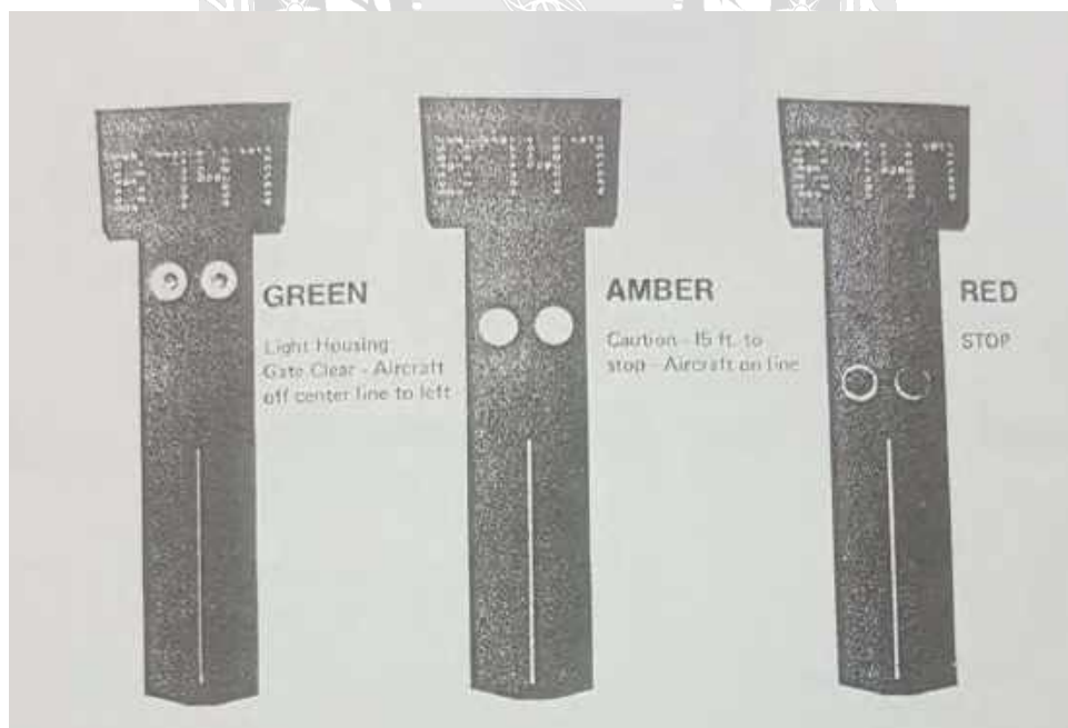
รูปที่ 2.24 B ส่วนแสดงผลของ DGS แบบ Inductive Loop Sensors
