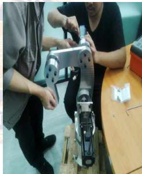
ภาพการต่อ Servo Motor เข้ากับ Servo Gearbox
