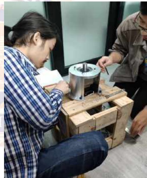
ภาพการเจาะรูชุด Servo Gearbox เข้ากับแขนกล
