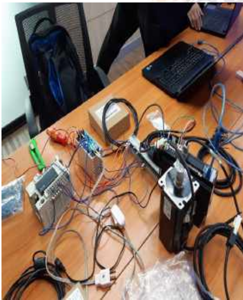
ภาพการต่อสายต่าง ๆ เข้ากับ PLC
