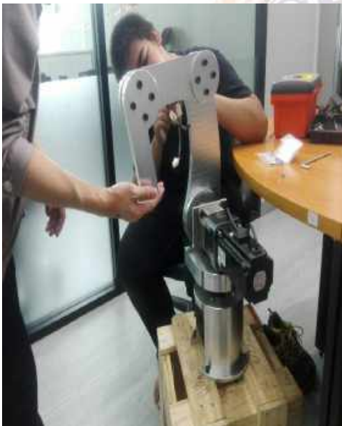
ภาพการต่อ Servo Motor เข้ากับ Servo Gearbox
