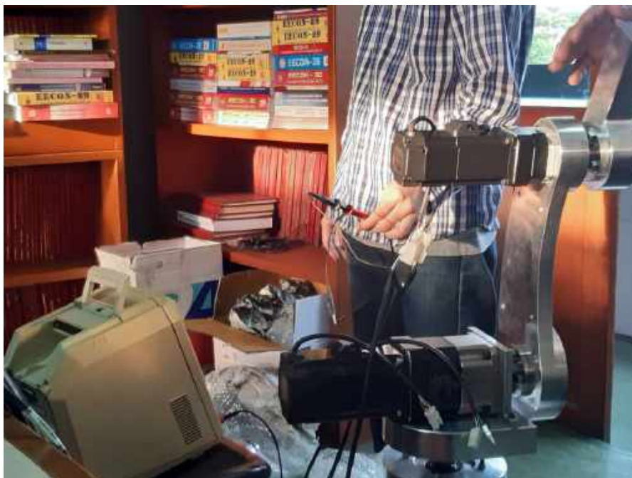
รูปที่ 4.35 การใช้ฮอสซิลโลสโคปตรวจสอบการทำงานของ Servo Motor
