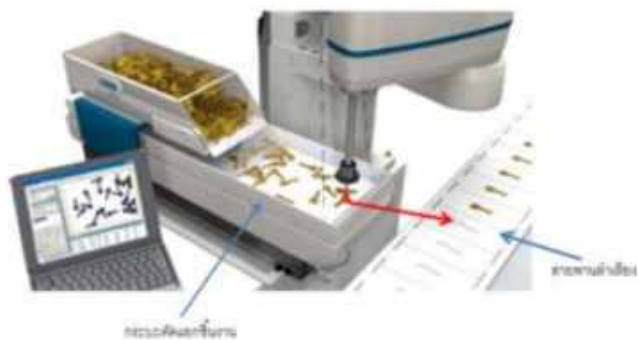
รูปที่ 2.8 การคัดเลือกชิ้นงานจากกระบวนนำมาวางที่สายพานลำเลียง
