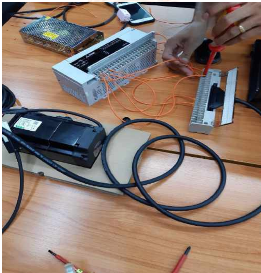
รูปที่ 4.32 การใช้ PLC ควบคุมการทำงานของ Servo Motor
