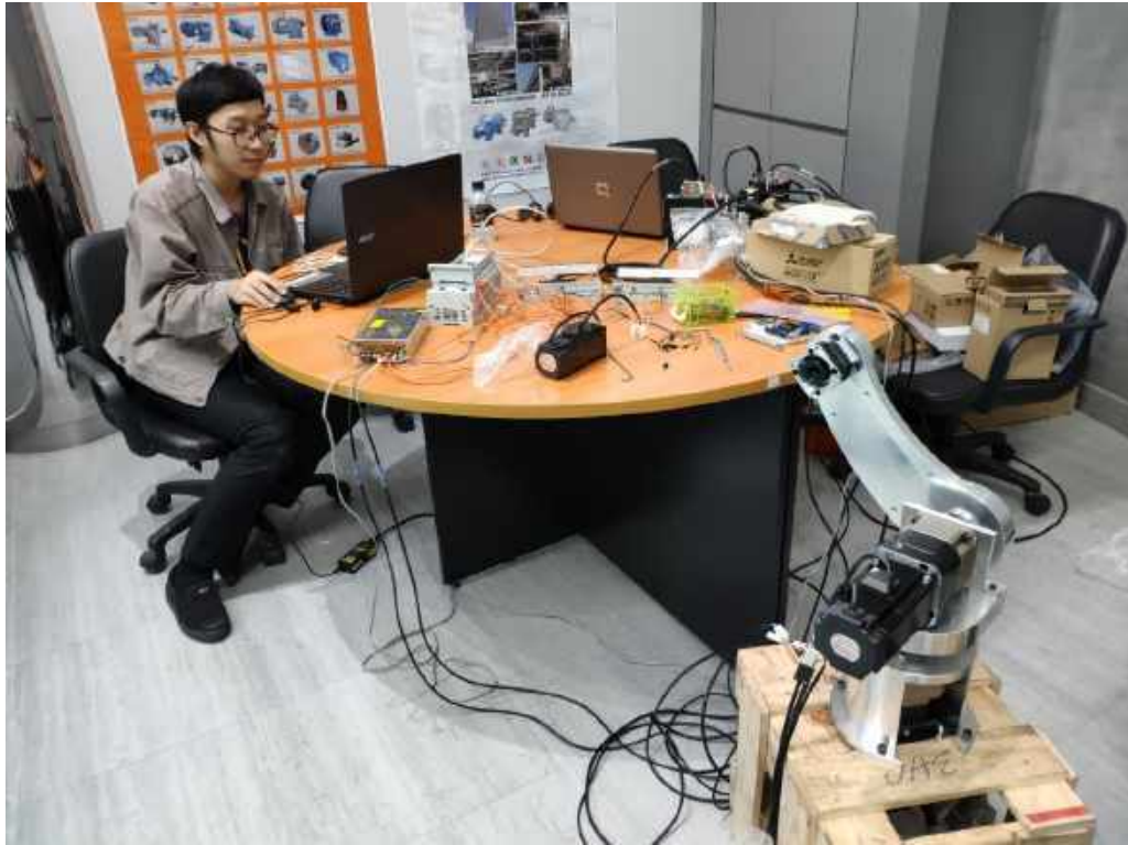
รูปที่ 4.33 การใช้ PLC ทดลองควบคุมการทำงานของ Servo Motor กับแขนกล
