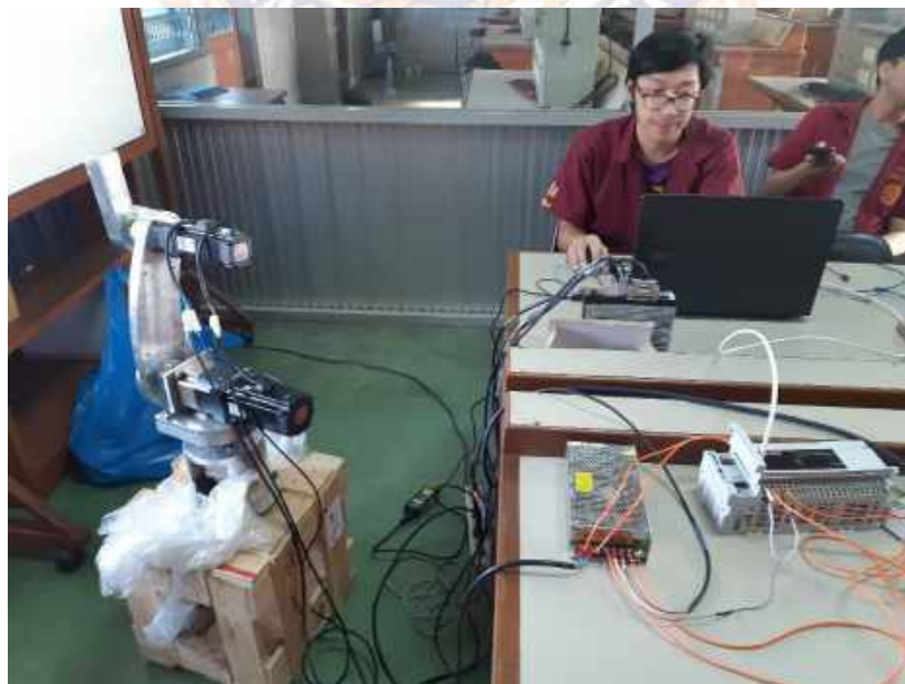
รูปที่ 4.34 ใช้ PLC ตรวจสอบการทำงานของ Servo Motor แต่ละข้อต่อ
