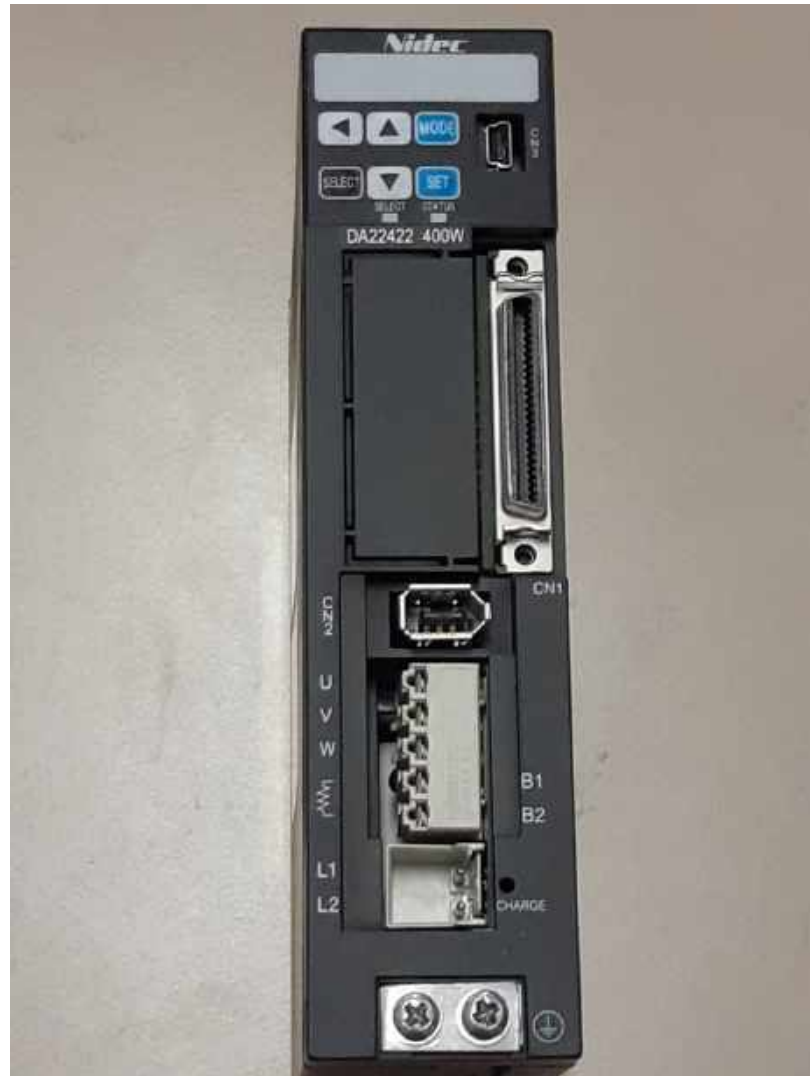
รูปที่ 2.19 เซอร์โวไดรฟ์เวอร์ (Servo Driver)
