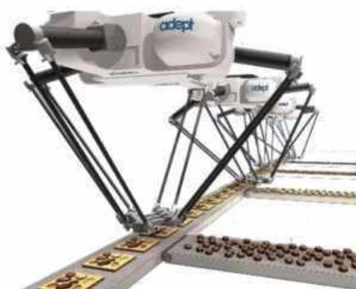
รูปที่ 2.5 แขนกล Parallel
