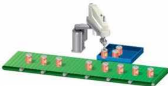
รูปที่ 2.6 การหยิบหรือเคลื่อนย้ายชิ้นงานจากสายพานมาไว้ในลัง
