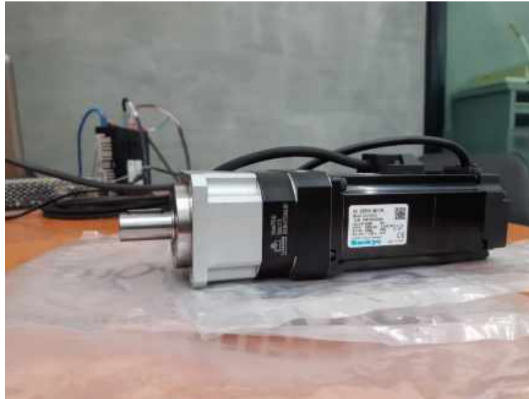
รูปที่ 4.23 การใช้งาน Servo Motor ขับ Servo Gearbox
