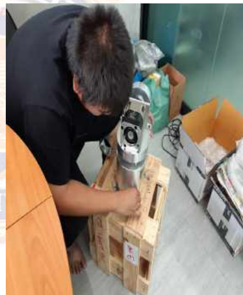
ภาพการซีด Servo Gearbox เข้ากับแขนกล
