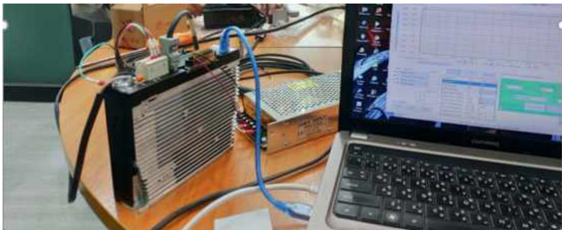
รูปที่ 4.19 การต่อสาย USB จาก Servo Driver เข้าคอมพิวเตอร์
