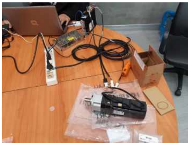
รูปที่ 4.18 การต่อสายจาก Servo Driver เข้ากับสายของ Servo Motor
