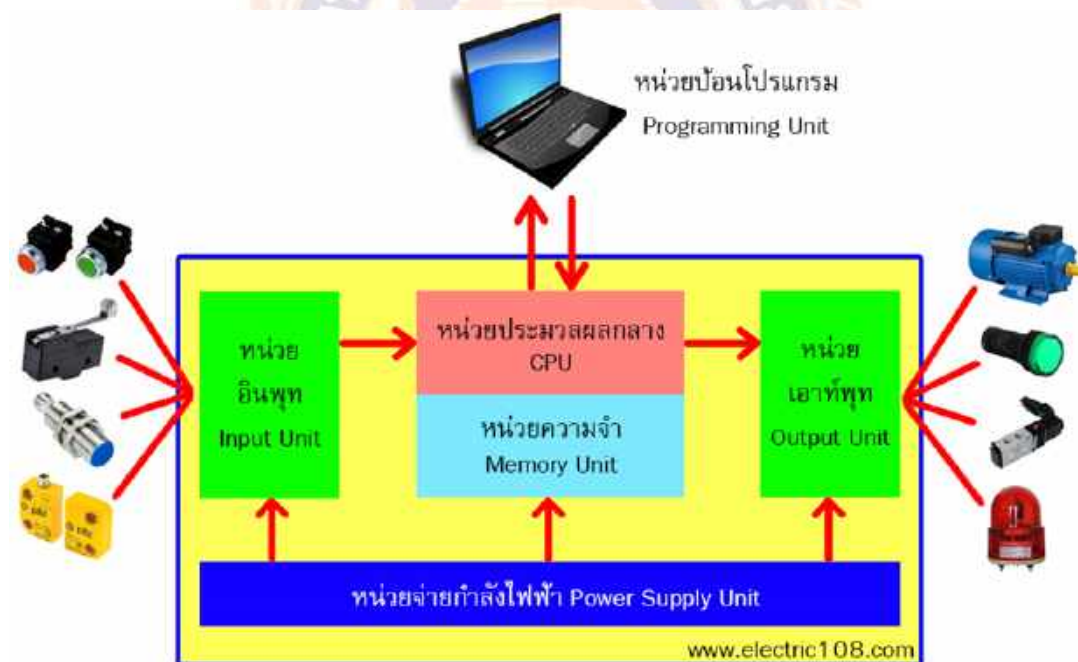
รูปที่ 2.24 โครงสร้างของ PLC
