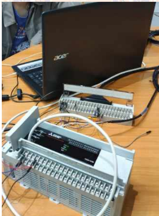
รูปที่ 4.24 การต่อสาย LAN จาก PLC เข้ากับคอมพิวเตอร์
