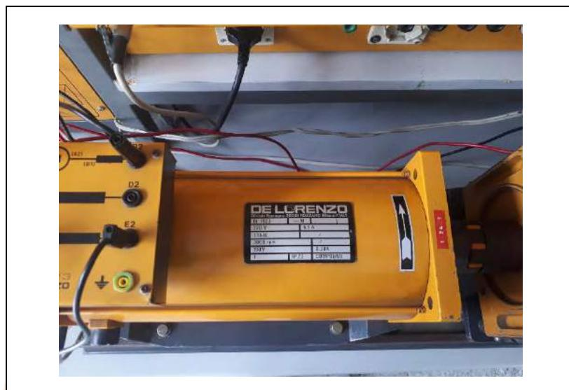
รูปที่ 0.21 มอเตอร์ไฟฟ้ากระแสตรงชนิดแยกกระตุ้นที่ใช้ในงานวิจัย
