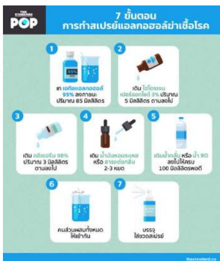
รูปที่ 3.8 7 ขั้นตอนการทำสเปรย์แอลกอฮอล์ฆ่าเชื้อโรค
