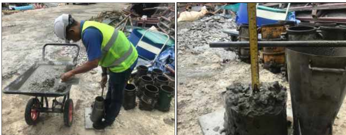
ภาพผนวกรูปที่ 13 การตรวจ Slump
