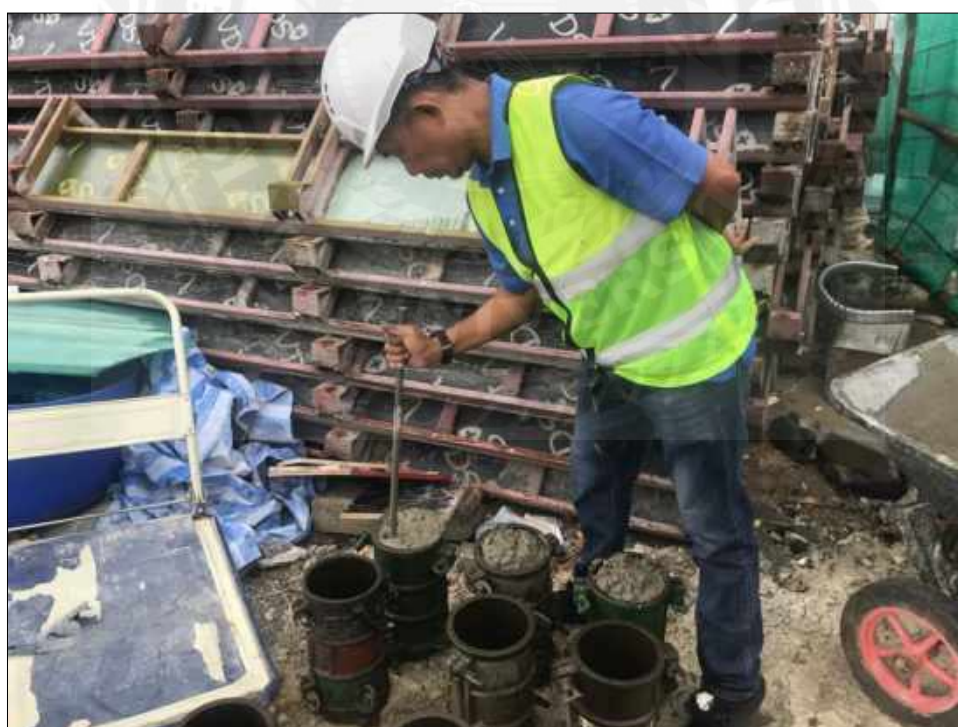
ภาพผนวกรูปที่ 14 เก็บตัวอย่างคอนกรีต
