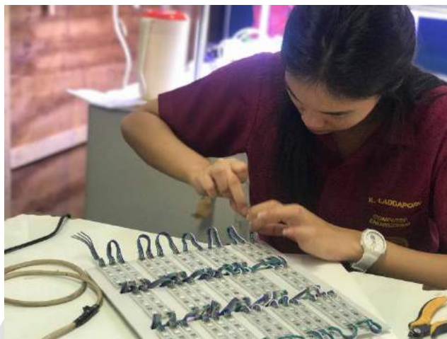
รูปที่ 1 การเชื่อมต่อสายหลอดไฟแอลอีดี (LED)
