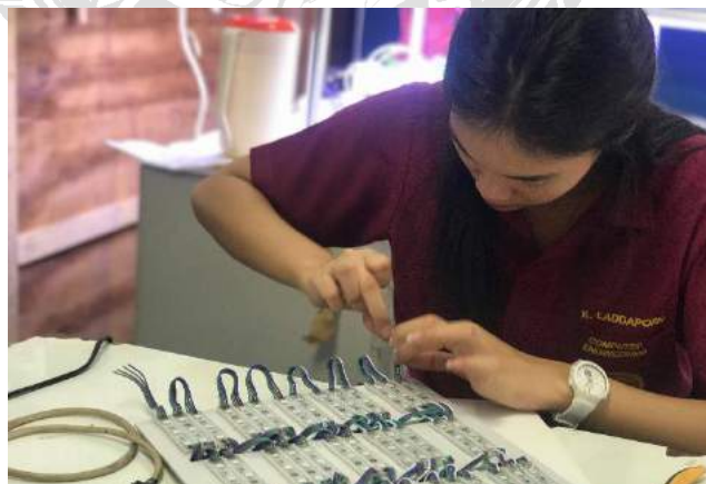
รูปที่ 4. 1 การติดตั้งหลอดไฟแอลอีดีแบบอาร์จีบี
