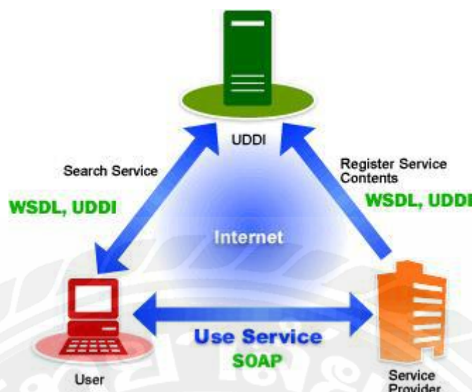
รูปที่ 2.4 ขั้นตอนการทำงานของ Web service
