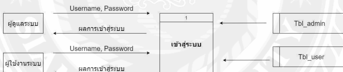
รูปที่ 3.6 Data Flow Diagram Level 1 ในส่วนของเข้าสู่ระบบ
