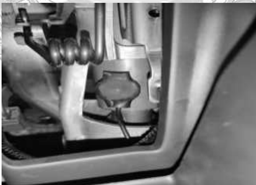
รูปที่ 3.4 การติดตั้งเครื่องวิเคราะห์เสียงผิดปกติส่วนแกนพวงมาลัย
