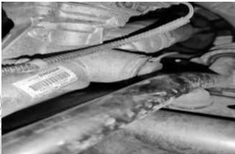
รูปที่ 3.3 การติดตั้งเครื่องวิเคราะห์เสียงผิดปกติส่วนแบริคพวงมาลัย
