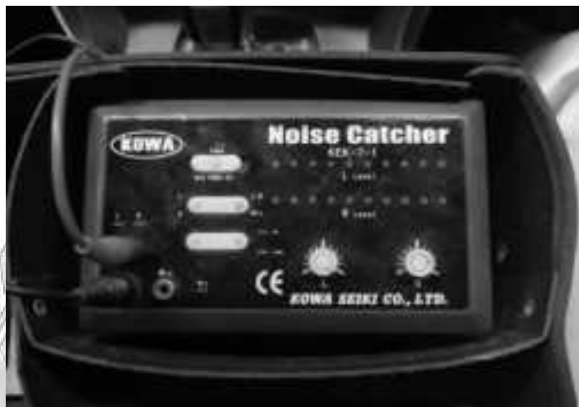
รูปที่ 3.5 การติดตั้งสายเข้ากับตัวเครื่องวิเคราะห์เสียงผิดปกติ
