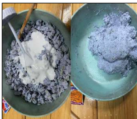
รูปที่ 4.7 นำมาผสมกับกาว ให้เหนียวจนปั้นเป็นรูปได้
