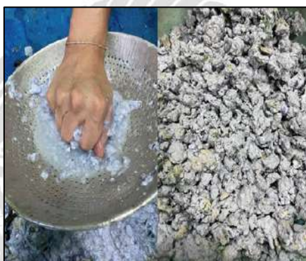
รูปที่ 4.6 กรองน้ำออกให้เหลือเพียงเยื่อกระดาศ
