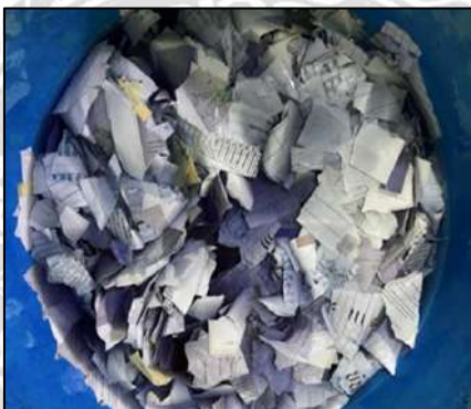
รูปที่ 4.3 นำกระดาษแช่น้ำ ทิ้งไว้ 22-24 ชั่วโมง
