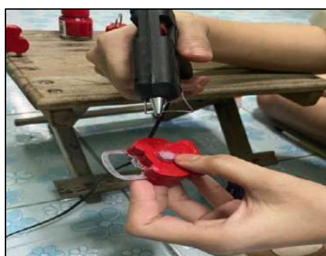
รูปที่ 4.13 ใช้ปืนกาวติดแม่เหล็ก แม่เหล็กสำหรับติดตู้เย็น
