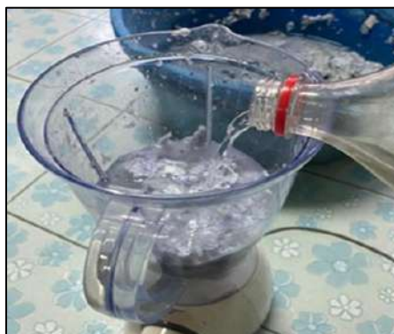
รูปที่ 4.4 กระดาษใส่งในเครื่องปั่นและเติมน้ำลงไปให้ท่วมกระดาษ
