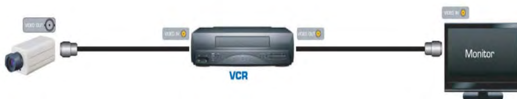
รูปที่ 2.3.1 โครงสร้างพื้นฐานของระบบ CCTV
