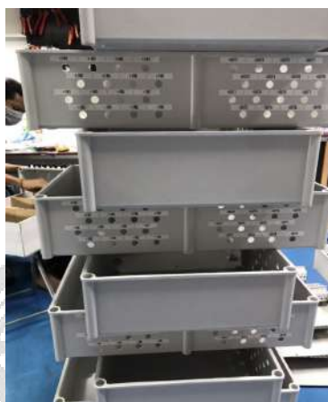
รูปที่ 4.7 การติดสติ๊กเกอร์ตามรูปที่เจาะ
