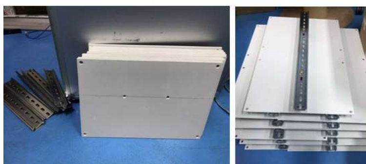
รูปที่ 4.9 การเจาะแผ่นหน้าตู้ควบคุมเพื่อติดตั้งอุปกรณ์
