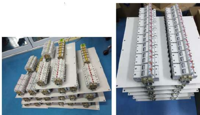
รูปที่ 4.10 การติดตั้งอุปกรณ์บนแผ่นหน้าตู้ควบคุม
