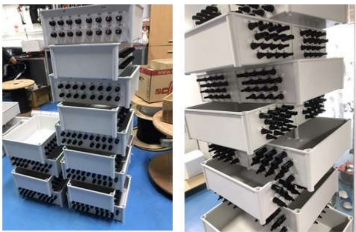
การติดตั้งเกอ์ตามรูที่เจาะ
