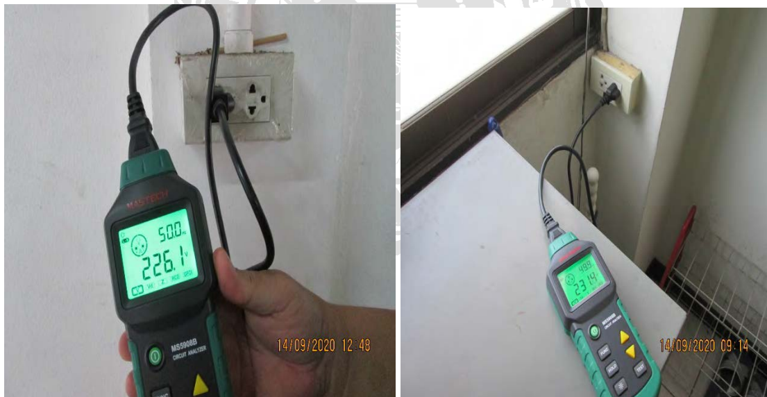
รูปที่ 4.29 มิเตอร์ MS5908A เครื่องทดสอบการติดตั้งระบบไฟฟ้า MASTE
