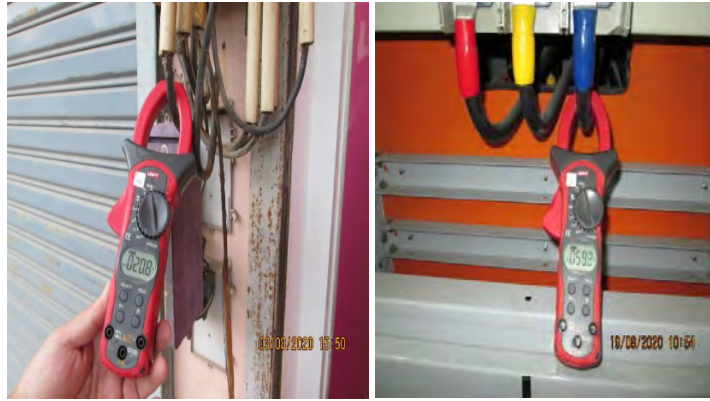
รูปที่ 4.30 เครื่องมือวัดชนิดคล้องสายหรือแคลมป์ออนมิเตอร์
