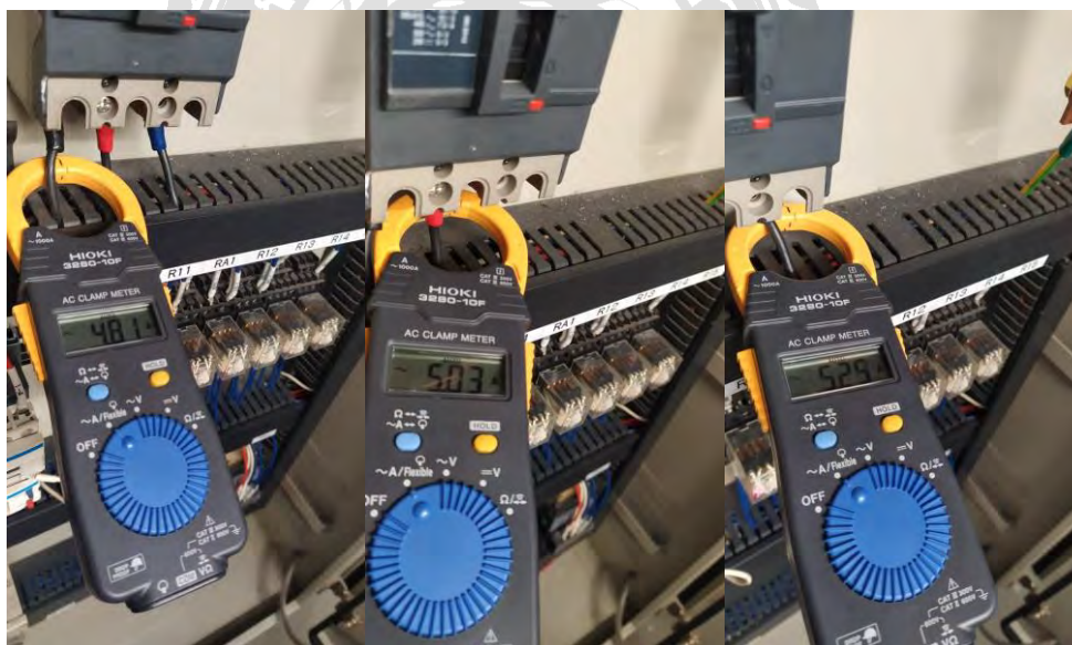
รูปที่ 4.17 ตรวจสอบวัดกระแสขณะ Pressurized fan ทำงาน
